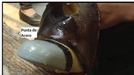
**FIGURA 10** Colocación de Punta de Acero
