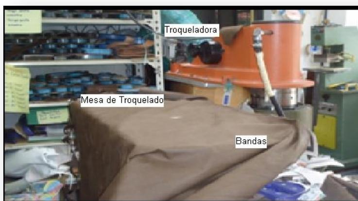
**FIGURA 4: Máquina Troqueladora de Brazo**
