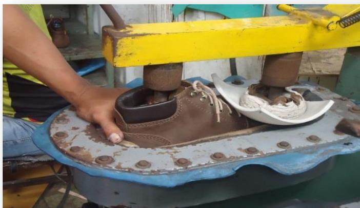
**FIGURA 15: Prensado de Calzado**
