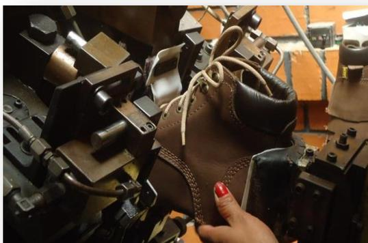
**FIGURA 11:** Armado de Punta
