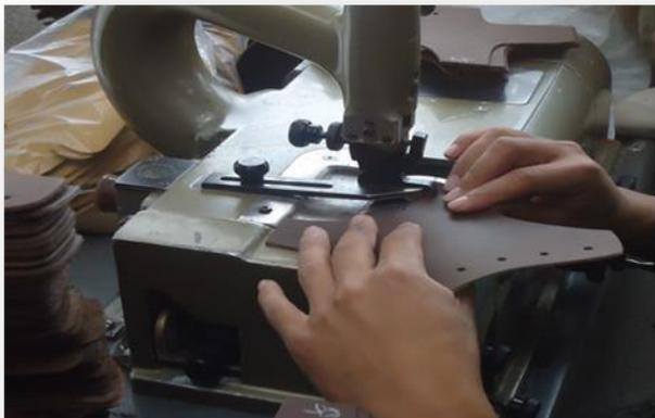
**FIGURA 5: Máquina Destalladora**
