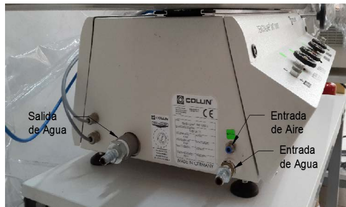
Figura 4.5: Conexión de Agua y Aire del Vacuum "VKT 100 T"
