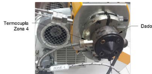
Figura 12: Conexión de Termocuplas
