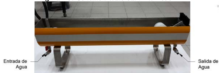
Figura 13: Conexión Waterbath "WB 850 T"
