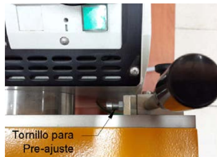
Figura 4.10: Pre-ajuste de la brecha de alimentación
