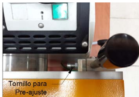
Figura 13: Pre-ajuste de la brecha de alimentación
