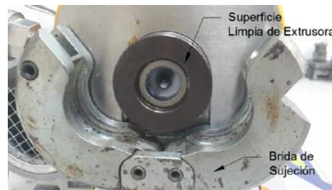
Figura 8: Preparación del Equipo
