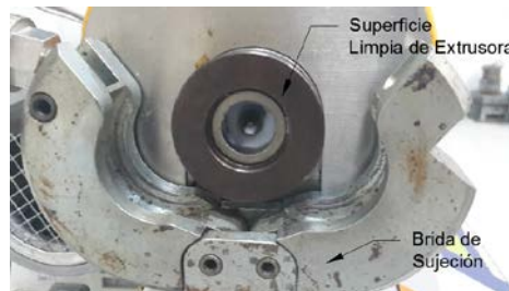
Figura 9: Preparación del Equipo
