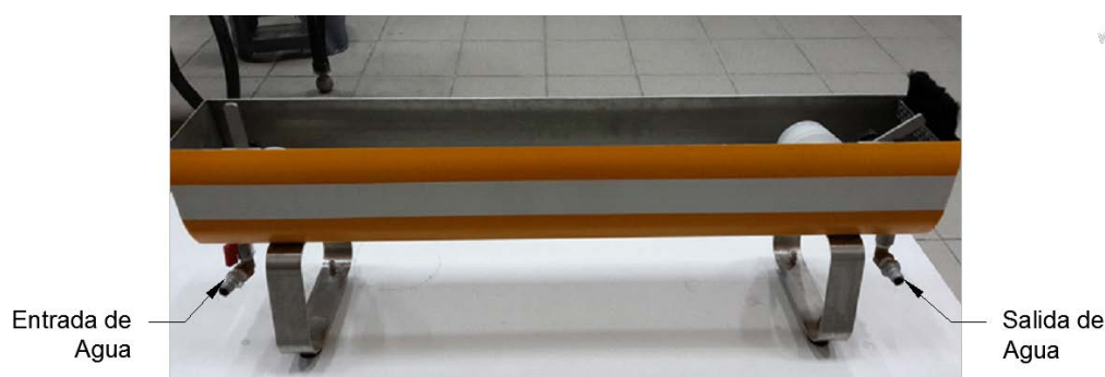
Figura 4.3: Conexión de Agua Waterbath "WB 850 T"
