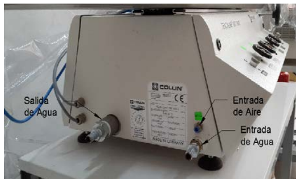
Figura 13: Conexión de Agua y Aire del Vacuum "VKT 100 T"
