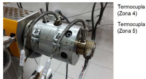
Figura 11: Conexión de Termocuplas
