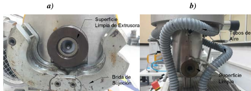
Figura 4: Preparación del Equipo
