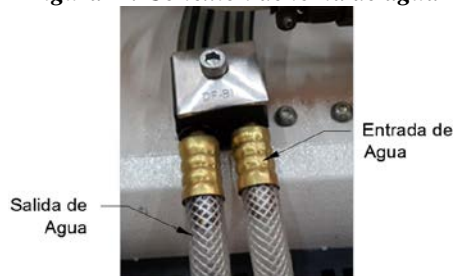
Figura 7: Conexión de toma de agua
