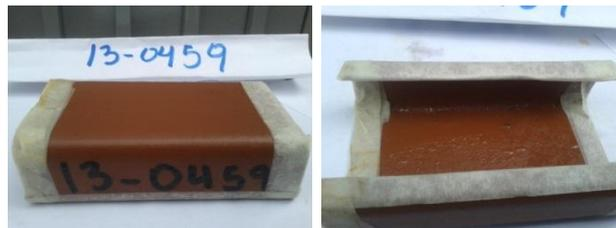
Después de 150 horas del tratamiento probeta 13-0459:
