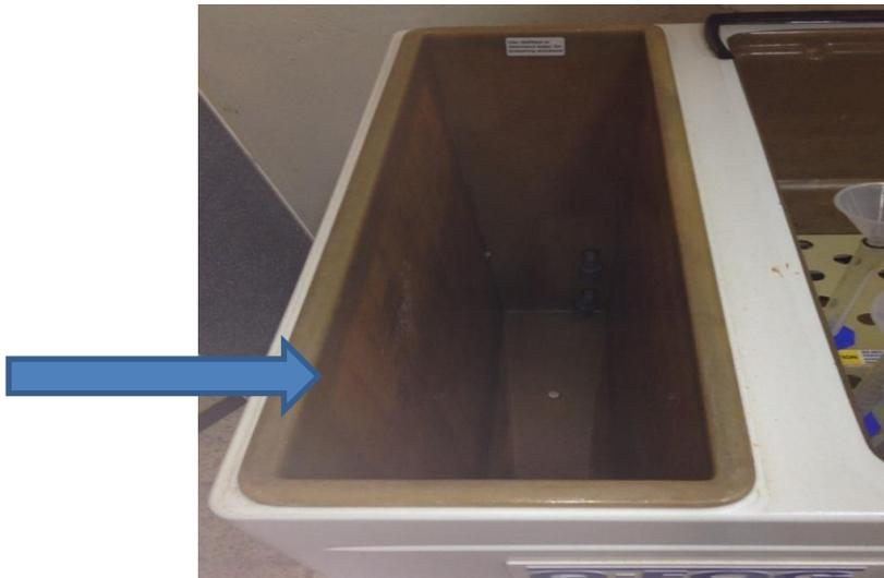
**Figura 2-7:** Depósito de solución salina
