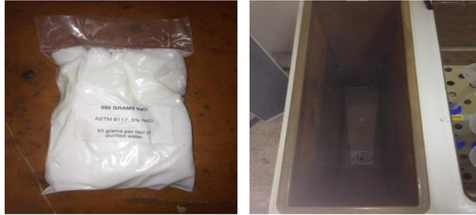
**Figura 3-8:** Cloruro de sodio NaCl y tanque de solución salina.
