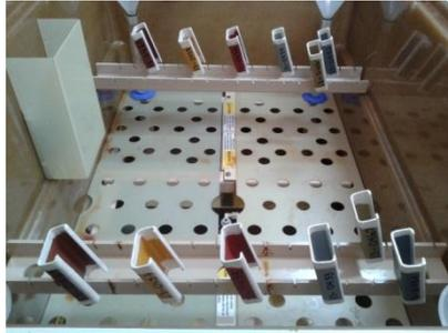
**Figura 3-11:** Disposición de las muestras en la cámara salina
