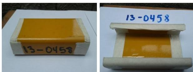
Después de 43 horas del tratamiento probeta 13-0458:
