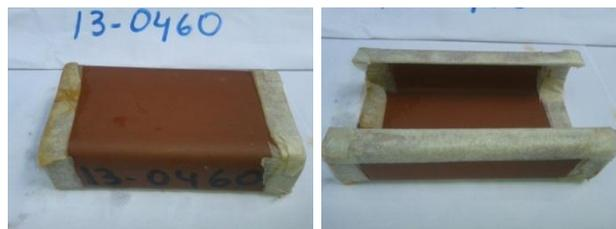
Después de 150 horas del tratamiento probeta 13-0460:
