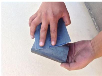
Figura 3-4: Lijado de una probeta a ser utilizada.
