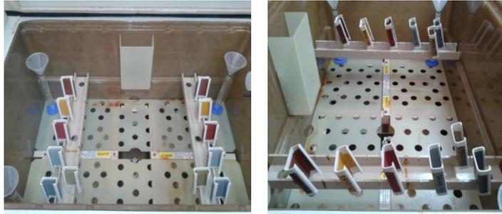
**Figura 3-16:** Vista general de las 12 muestras montadas en la cámara de niebla salina, previo al ensayo.
