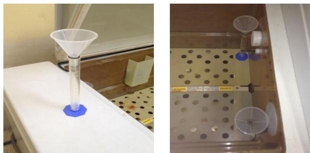
**Figura 3-10:** Torres de control de dispersión homogénea de la cámara
