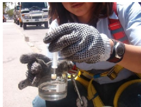
Verificación presencia de agua
