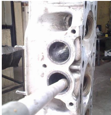
Fig. 3-6 Pulverizado de Cabezote de Chevrolet Luv con gasolina. Fuente: Autores
