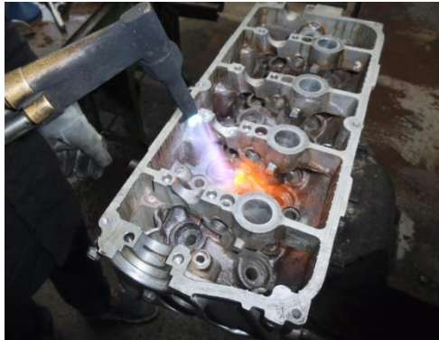
Fig. 4-15 Precalentamiento para el proceso de soldadura.
