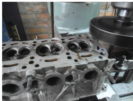
Fig. 4-28 Proceso de cepillado de Cabezote Chevrolet Swift Automotriz. Fuente: Autores.
