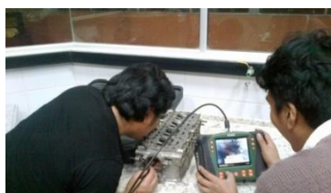
Fig. 3-14 Inspección Visual con el Boroscopio de la cámara de refrigeración del cabezote Chevrolet Swift. Fuente: Autores
