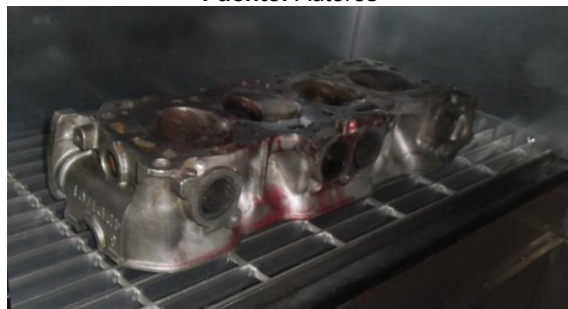
Fig. 3-27 Secado de Cabezote Chevrolet Luv en el Sistema de Inspección por líquidos penetrantes fluorescentes de lavado de agua.
