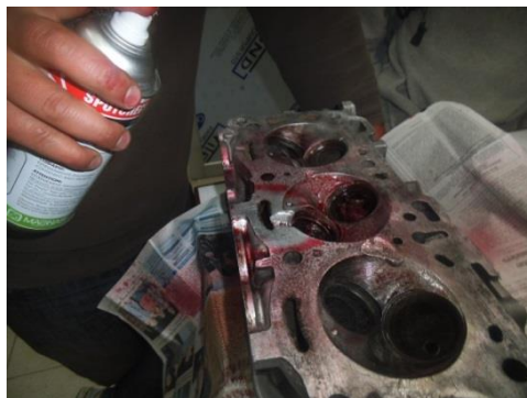
Fig. 4-38 Aplicación del revelador Magnaflux en la Cámara de Combustión en Cabezote de Chevrolet Luv.
