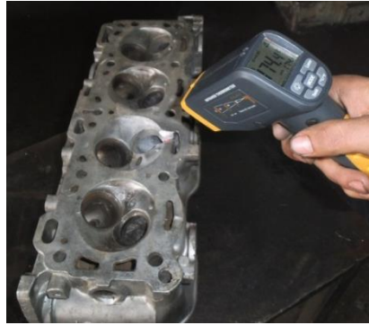
Fig. 4-23 Control de Temperatura en cabezote con termómetro. Fuente: Autores.
