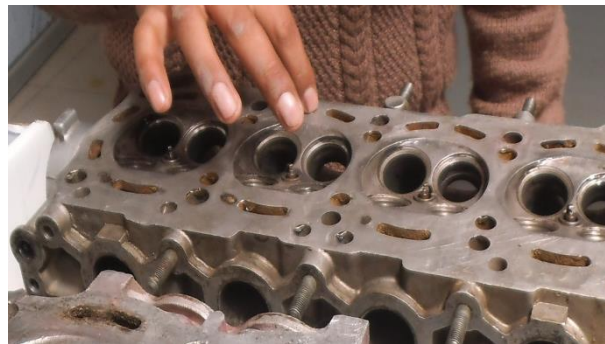
Fig. 3-38 Colocación de Gel Sonotech-Magnaflux en Cabezote de Chevrolet Swift Automotriz. Fuente: Autores.
