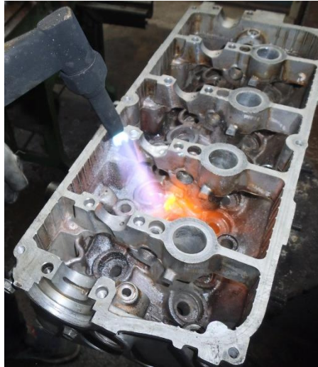
Fig. 4-19 Tratamiento térmico en de Cabezote de Chevrolet Swift Automotriz. Fuente: Autores.
