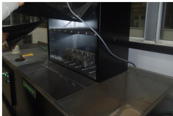
Fig. 4-34 Lavado con Agua el penetrador Cabezote de Chevrolet Swift Sistema de Inspección por líquidos penetrantes fluorescentes de lavado de agua.
