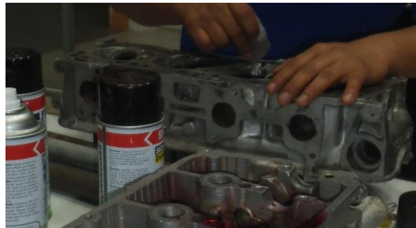
Fig. 4-21 Limpieza de Cabezote de Chevrolet Luv para el proceso de soldadura. Fuente: Autores.
