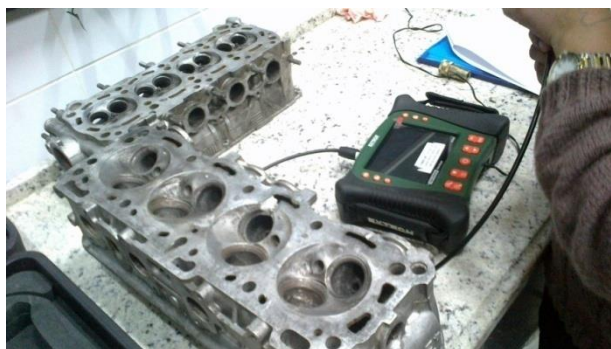
Fig. 3-9 Cabezote de Chevrolet Swift, Cabezote Chevrolet Luv y Boroscopio Industrial Extech. Fuente: Autores
