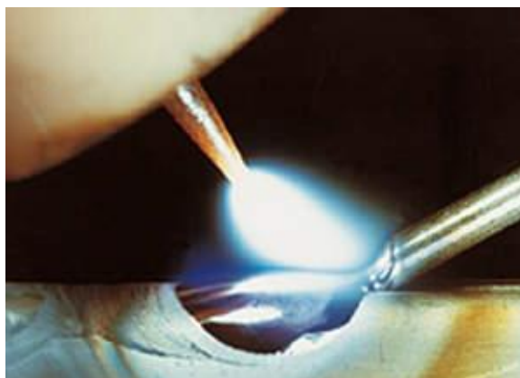
Fig. 4-9 Proceso de soldadura Tig. Fuente: www.actiweb.es
