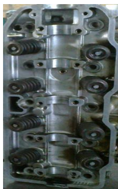
Fig. 3-11 Inspección Visual con el Boroscopio de la cámara de lubricación de cabezote Chevrolet Luv. Fuente: Autores
