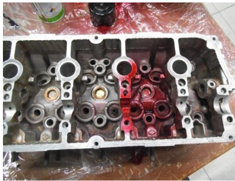
Fig. 4-32 Aplicación del penetrador Magnaflux en la Cámara de Lubricación de Cabezote de Chevrolet Swift.
