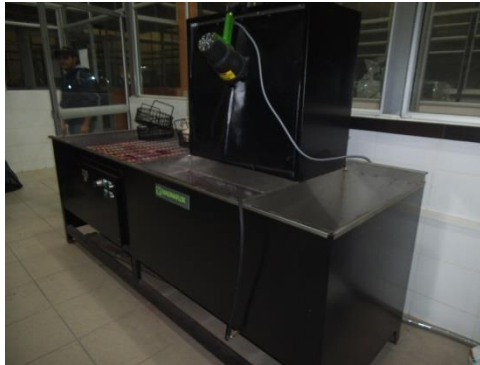
Fig. 3-21 Sistema de inspección por líquidos penetrantes fluorescentes de lavado de agua, ZA-1633 Método A
