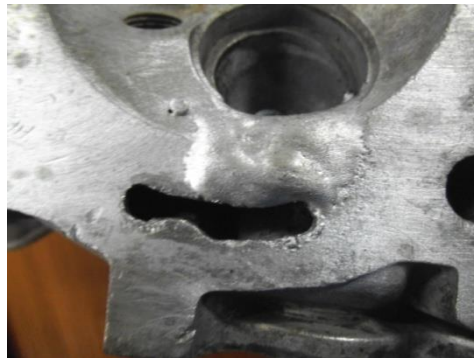
Fig. 4-26 Limpieza de escorias luego del proceso de soldadura. Fuente: Autores.
