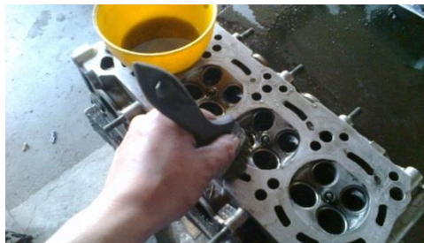
Fig. 3-3 Limpieza de Cabezotes con desengrasante. Fuente: Autores
