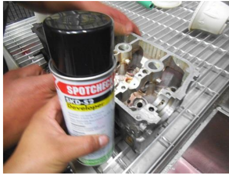
Fig. 4-37 Aplicación del revelador Magnaflux en la Cámara de Lubricación de Cabezote de Chevrolet Swift.
