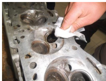
Fig. 3-20 Limpieza Cámara de Combustión en Cabezote Chevrolet Luv. Fuente: Autores
