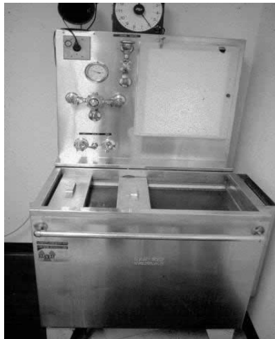
Fig. 2-12 Tanque de procesamiento manual de cinta radiográfica.
