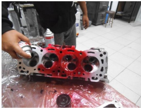
Fig. 4-33 Aplicación del penetrador Magnaflux en la Cámara de Combustión de Cabezote de Chevrolet Luv.
