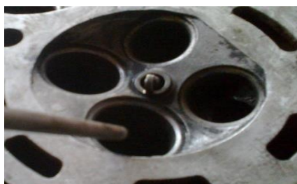
Fig. 3-12 Inspección Visual cámara de la combustión del cabezote de Chevrolet Swift. Fuente: Autores
