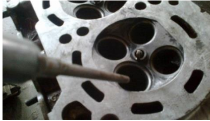
Fig. 3-5 Pulverizado de Cabezotes de Chevrolet Swift con gasolina. Fuente: Autores
