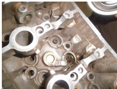
Fig. 4-18 Limpieza de escorias luego del proceso de soldadura. Fuente: Autores.
