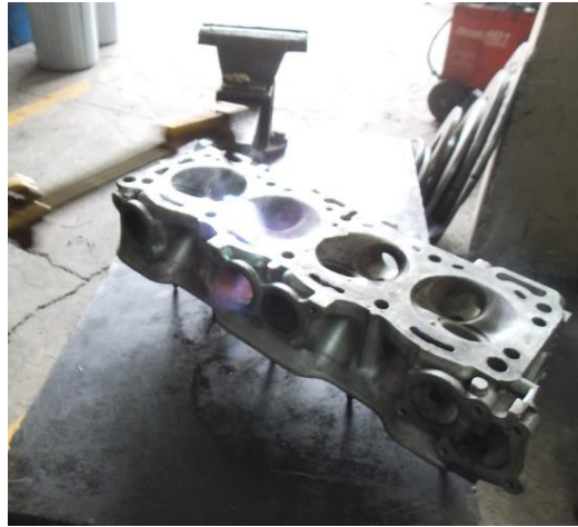
Fig. 4-27 Tratamiento térmico en de Cabezote de Chevrolet Luv luego del proceso de soldadura con Tig. Fuente: Autores.
