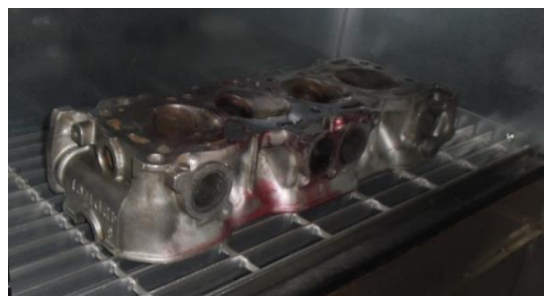
Fig. 4-36 Secado de Cabezote Chevrolet Luv en el Sistema de Inspección por líquidos penetrantes fluorescentes de lavado de agua.
