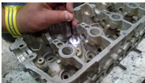
Fig. 3-10 Inspección Visual de la cámara de lubricación del cabezote de Chevrolet Swift. Fuente: Autores
