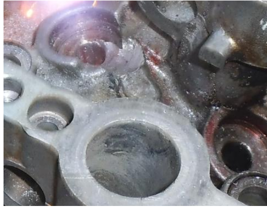
Fig. 4-13 Junta para la realización del proceso de soldadura con electrodo revestido. Fuente: Autores.
