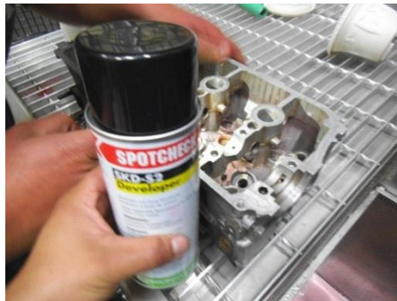
Fig. 3-28 Aplicación del revelador Magnaflux en la Cámara de Lubricación de Cabezote de Chevrolet Swift.
