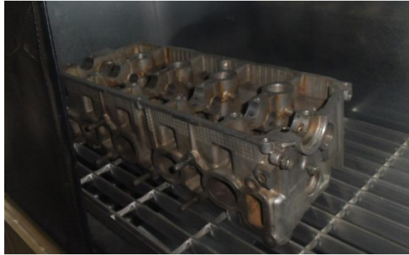
Fig. 3-26 Secado de Cabezote Chevrolet Swift en el Sistema de Inspección por líquidos penetrantes fluorescentes de lavado de agua.
