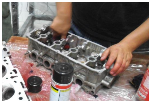
Fig. 4-30 Limpieza de Cabezote Chevrolet Swift Automotriz. Fuente: Autores.
