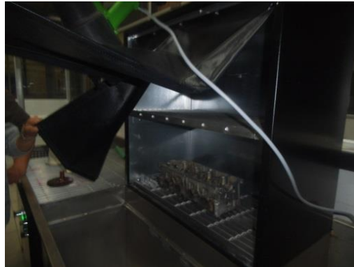
Fig.4.27 Secado de Cabezote Chevrolet Swift en el Sistema de Inspección por líquidos penetrantes fluorescentes de lavado de agua.
