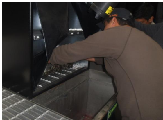
Fig. 4-35 Lavado con Agua el penetrador Cabezote de Chevrolet Luv Sistema de Inspección por líquidos penetrantes fluorescentes de lavado de agua.
