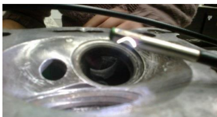
Fig. 3-13 Inspección Visual de la cámara de combustión del cabezote de Chevrolet Swift. Fuente: Autores
