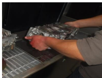
Fig. 3-25 Lavado con Agua el penetrador Cabezote de Chevrolet Luv Sistema de Inspección por líquidos penetrantes fluorescentes de lavado de agua.
