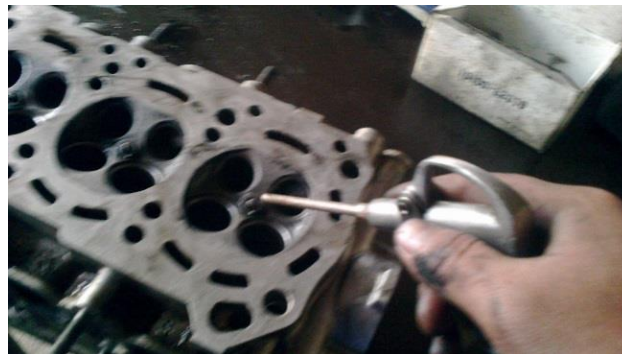
Fig. 4-14 Limpieza de Cabezote de Chevrolet Swift Automotriz para el proceso de soldadura con electrodo revestido. Fuente: Autores.
