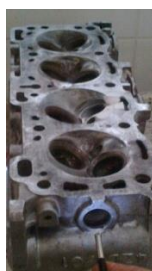
Fig. 3-15 Inspección Visual con el Boroscopio de la cámara de refrigeración del cabezote Chevrolet Swift. Fuente: Autores
