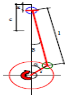
Fig. 1-2 Desplazamiento de pistón. Fuente: Autores.
