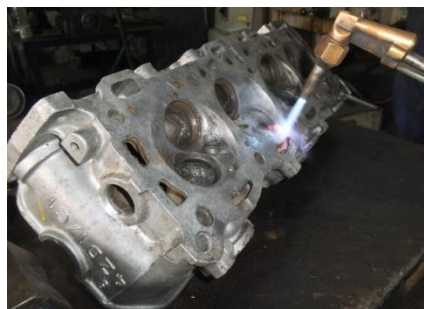
Fig. 4-22 Precalentamiento para el proceso de soldadura. Fuente: Autores.
