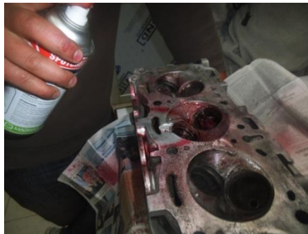
Fig. 3-29 Aplicación del revelador Magnaflux en la Cámara de Combustión en Cabezote de Chevrolet Luv.
