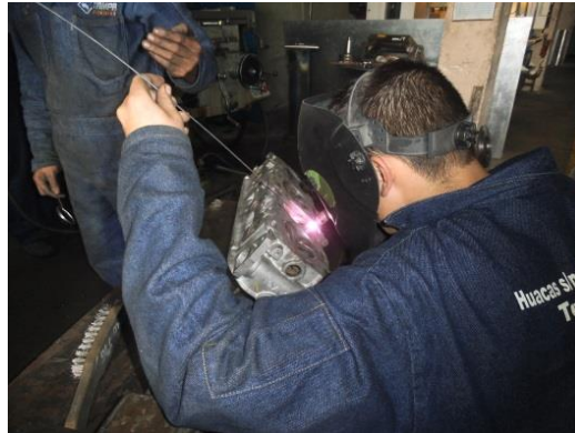
Fig. 4-25 Soldadura con proceso Tig de aluminio. Fuente: Autores.
