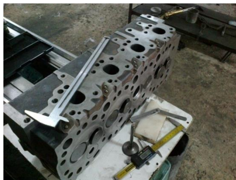
Fig. 1-14 Comprobación de holgura de la válvula. Fuente. Autores.
