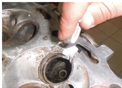
Fig. 4-20 Junta para la realización del proceso de soldadura Tig. Fuente: Autores.
