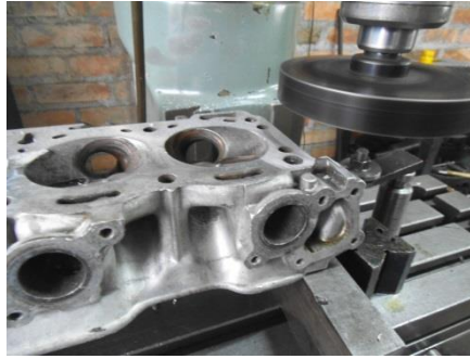
Fig. 4-29 Proceso de cepillado de Cabezote Chevrolet Luv Automotriz. Fuente: Autores.
