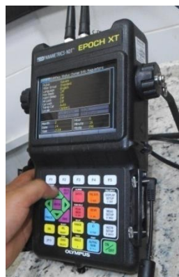
Fig. 3-30 Detector de defectos por ultrasonidos EPOCH XT Fuente: Autores
