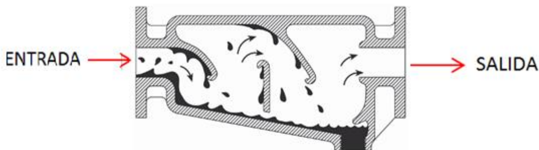
Fig. 1-5: SEPARADOR DE GOTAS (FUENTE: (SARCO, DISTRIBUCION DEL VAPOR, 1998))
