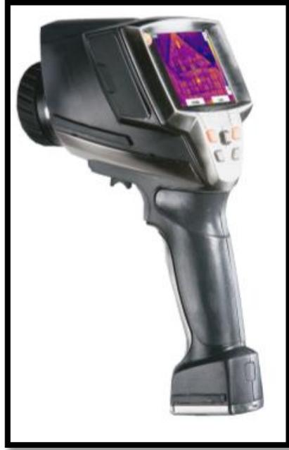
Gráfico 22: Testo 882 Cámara termográfica
