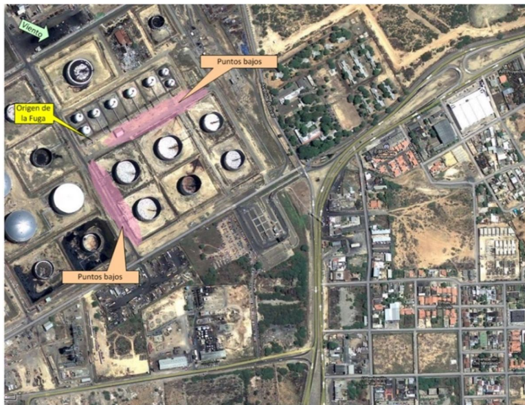
Figura 1.1.1: Concentración de gases debido a disminución de velocidad del viento.
