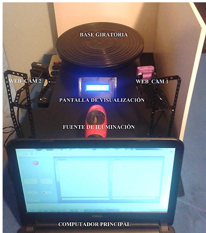
Figura 23. Elementos del escáner bifocal tridimensional
