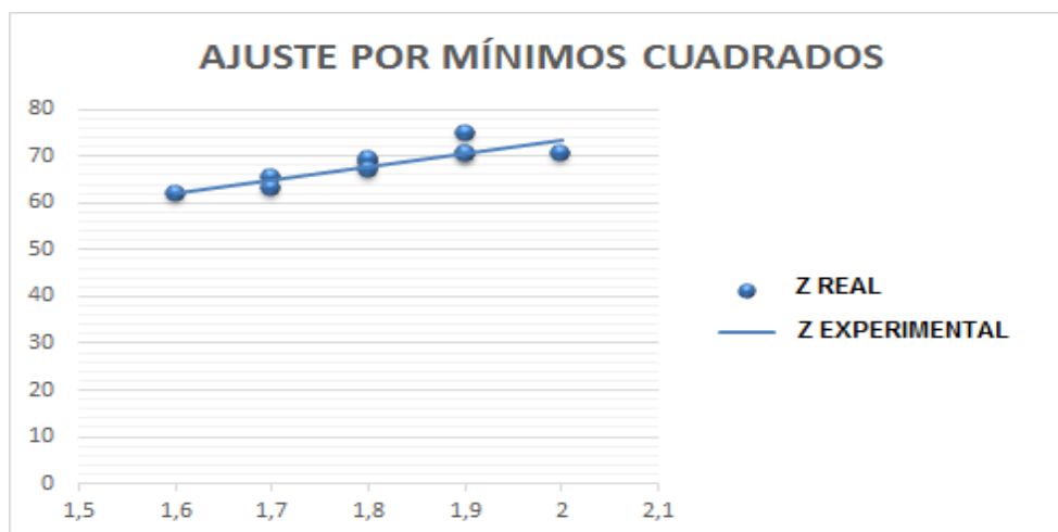
Figura 48. Ajuste por mínimos cuadrados para el cálculo de profundidades experimentales
