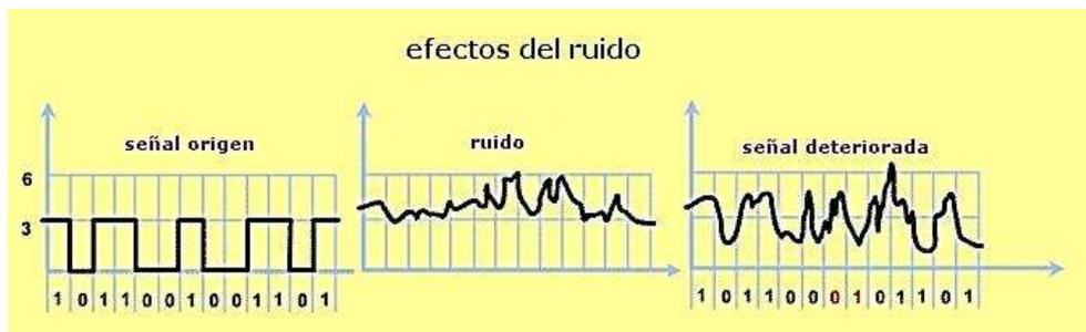
**Figura 2.6.5:** Deterioro de una señal a causa del ruido.
