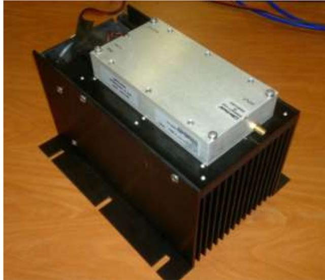
**Figura 2.13.1:** Amplificador de Potencia Mini-Circuits ZHL-50W-52-S(+).
