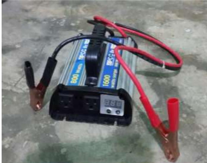
**Figura 2.14.1:** Inversor de Voltaje utilizado en el proyecto.
