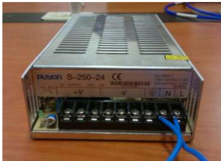
**Figura 2.15.1:** Fuente de poder utilizada en el proyecto.
