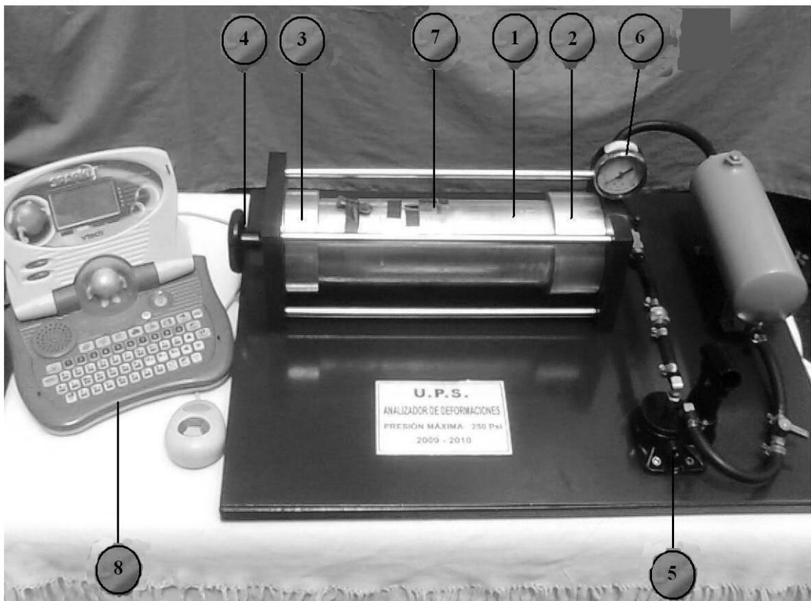
Figura 3-1. Analizador de deformaciones
