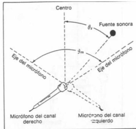
**Figura 21** Esquema angular de la configuración de micrófonos y la fuente de sonido [62]
