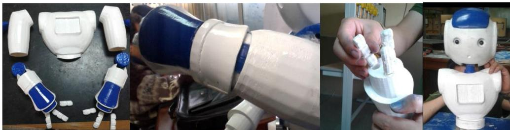
**Figura 50** Sujeción de los brazos, dedos y cabeza al tórax del robot.
