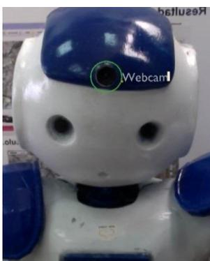
Figura 38 Configuración de la webcam en el robot
