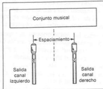
**Figura 22** Método de par espaciado [62]
