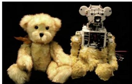
**Figura 3** Robot Huggable aspecto interno y externo [16]
