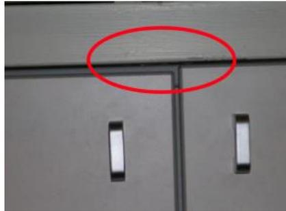
**Figura 6** Defecto originado por mal posicionado de taladros [48]
