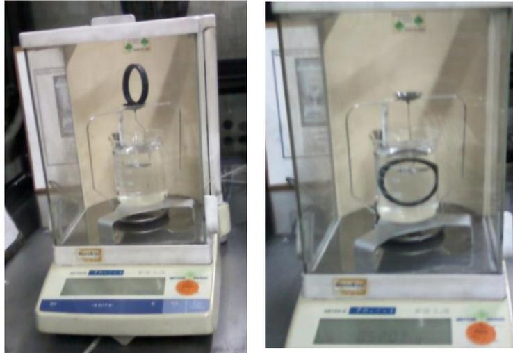
Fig. 2. 7 Conjunto para medir la densidad en probetas de caucho. Fuente: Autor
