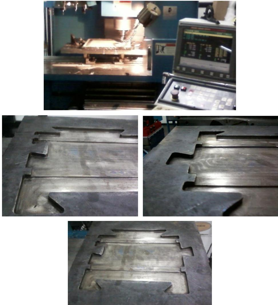
Fig.3. 12 Construcción del molde para piso de caucho.
