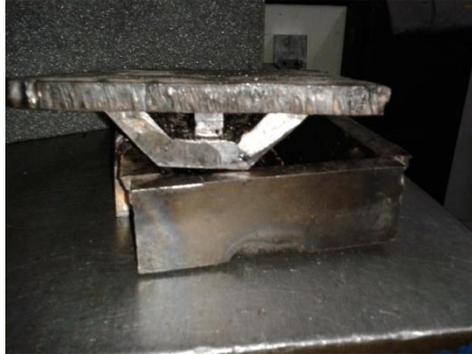
**Fig.3. 13** Construcción del molde para teja de caucho.
