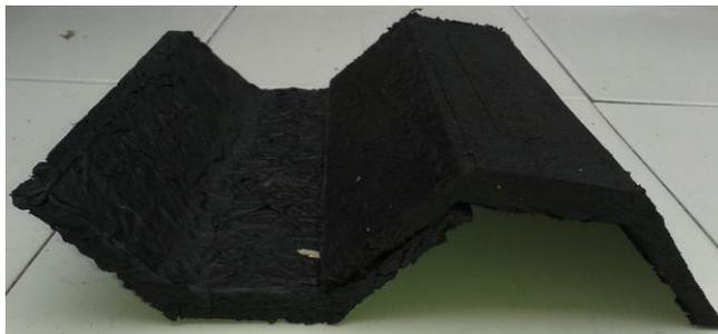
Fig.3. 15 Prototipos realizados en las pruebas, a) probetas de piso de F-NFU b) tejas de F-NFU.
