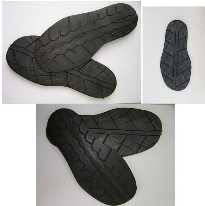
Fig.3. 5 Suelas de calzado con material reciclado. Fuente: [32]
