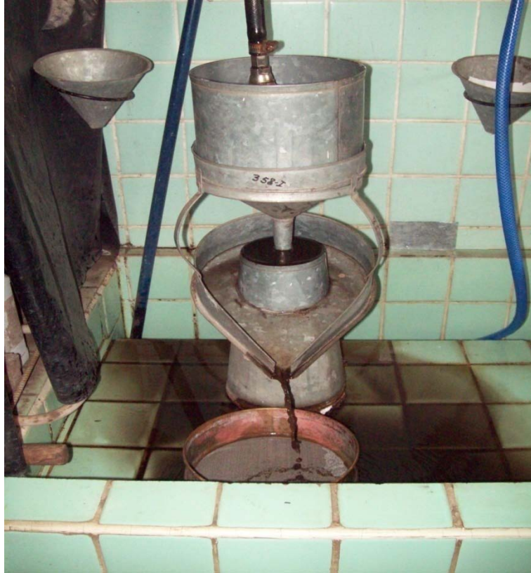
Foto 3. Proceso de lavado del suelo terminado y recolección del material flotante en un tamiz de 200 micras.
