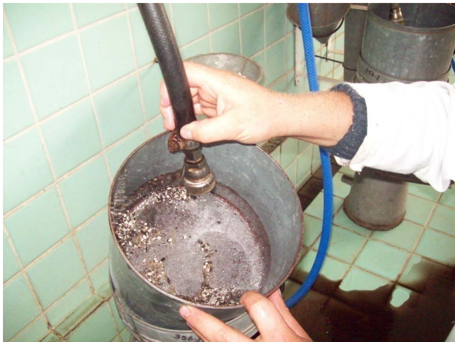
Foto 2. Material grueso del suelo que queda en el primer tamiz del elutriador de fenwick
