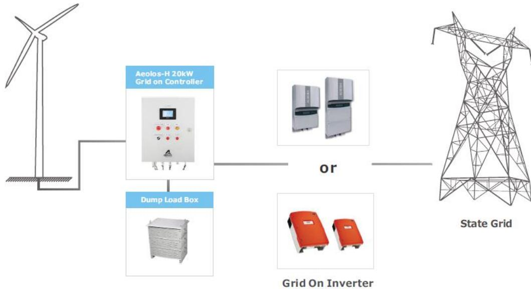
Figura 17 Sistema Eólico conectado a la red (AEOLOS, 2014)
