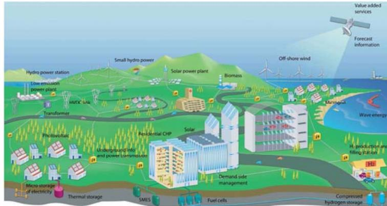
**Figura 2.** Diagrama de transición de redes eléctricas convencionales a Smart Grid. (EUROPEAN COMMISSION, 2006)
