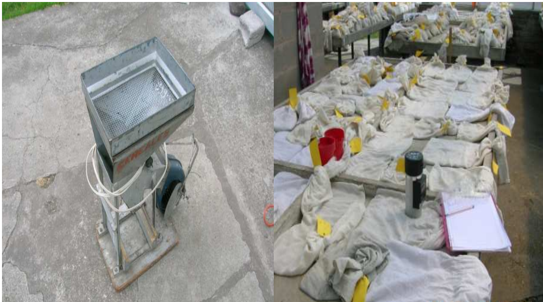
Fotografía 14. Ventilador experimental para la limpieza de granos y bandejas de secado bajo invernadero en la “Evaluación de siete variedades de trigo ( Triticum aestivum L.) con tres tipos de manejo nutricional a 2890 m.s.n.m. Juan Montalvo-Cayambe-2012”.
