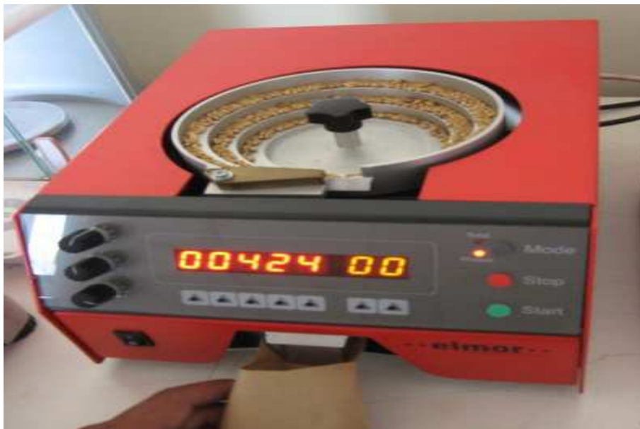
Fotografía 16. Contador de granos (semilla) electrónico utilizado para la determinación de la variable Peso de 1000 granos en la “Evaluación de siete variedades de trigo ( Triticum aestivum L.) con tres tipos de manejo nutricional a 2890 m.s.n.m. Juan Montalvo-Cayambe-2012”.
