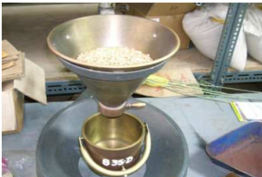
Fotografía 17. Balanza hectolétrica, utilizada para la determinación de la variable Peso Hectolétrico en la “Evaluación de siete variedades de trigo ( Triticum aestivum L.) con tres tipos de manejo nutricional a 2890 m.s.n.m. Juan Montalvo-Cayambe-2012”.
