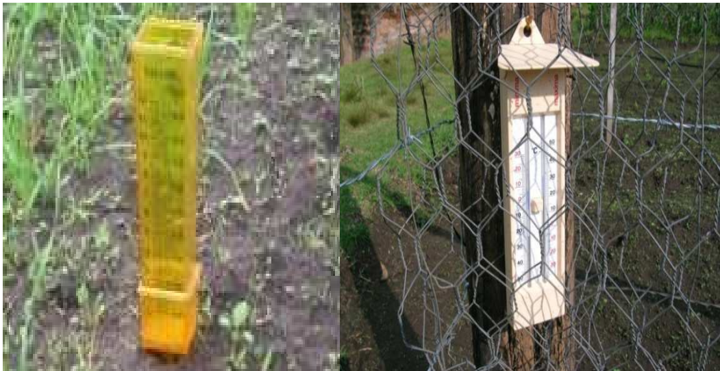
Fotografía 10. Instrumentos para medir precipitación (pluviómetro) y temperaturas máximas y mínimas diarias en la “Evaluación de siete variedades de trigo ( Triticum aestivum L.) con tres tipos de manejo nutricional a 2890 m.s.n.m. Juan Montalvo-Cayambe-2012”.
