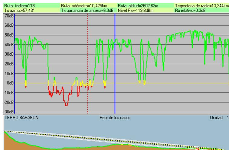
**Figura 1.78:** Cobertura de Radio en la Ruta Rural con Repetidora en Barabón. Fuente: Los Autores
