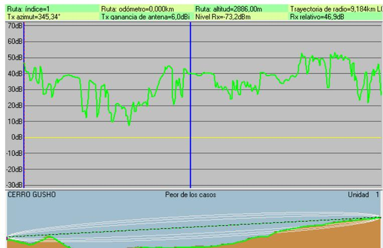
**Figura 1.90:** Cobertura de Radio en la Ruta Rural con Repetidora en Gusho. Fuente: Los Autores
