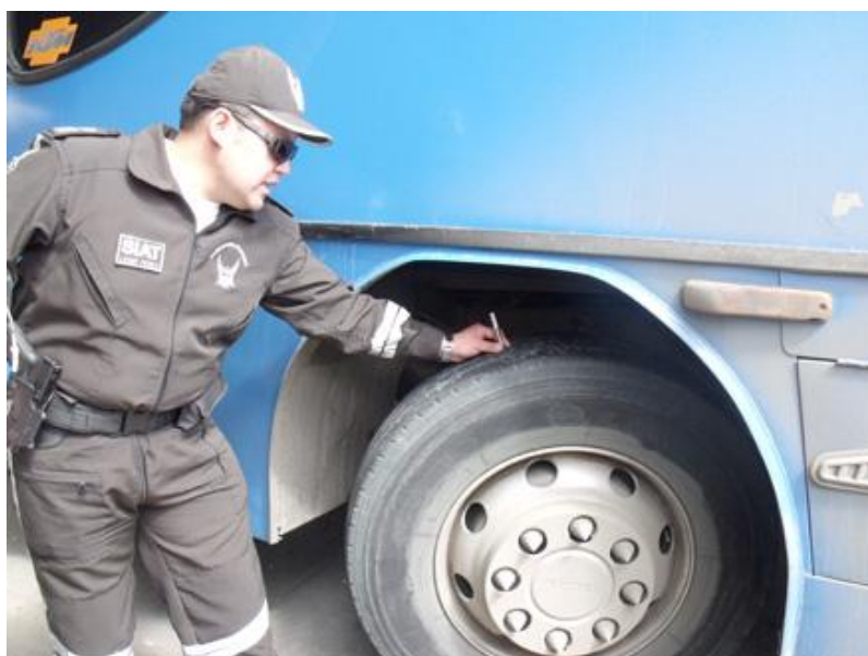
Gráfica 1.17 Medición de la banda de rodadura del neumático
