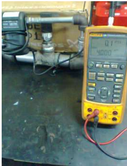
FIGURA 135: MEDICIÓN N°1 0 psi – 4 mA - 0%
