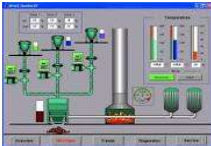
FIGURA 8: APLICACIÓN DE WINCC
