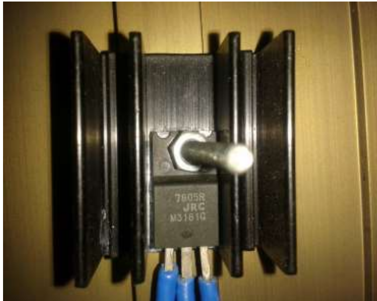
FIGURA 44: REGULADOR DE VOLTAJE 7805
