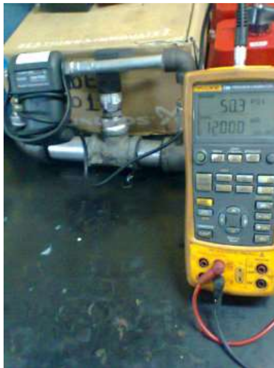
FIGURA 136: MEDICIÓN N°2 50 psi – 12 mA - 50%
