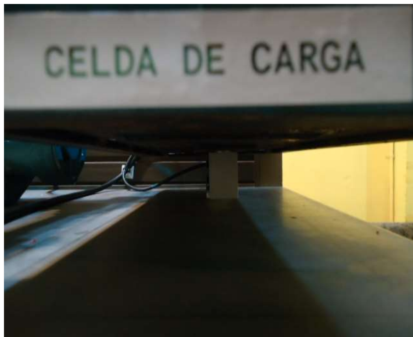
FIGURA 70: CELDA DE CARGA INSTALADA
