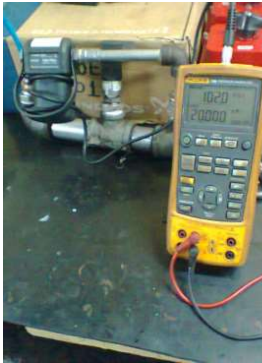
FIGURA 137: MEDICIÓN N°3 100 psi – 20 mA - 100%
