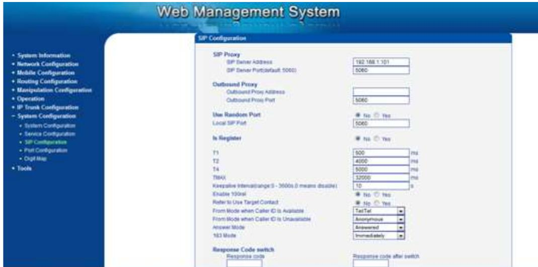
Figura 3.48 Configuración SIP DWG-2000
