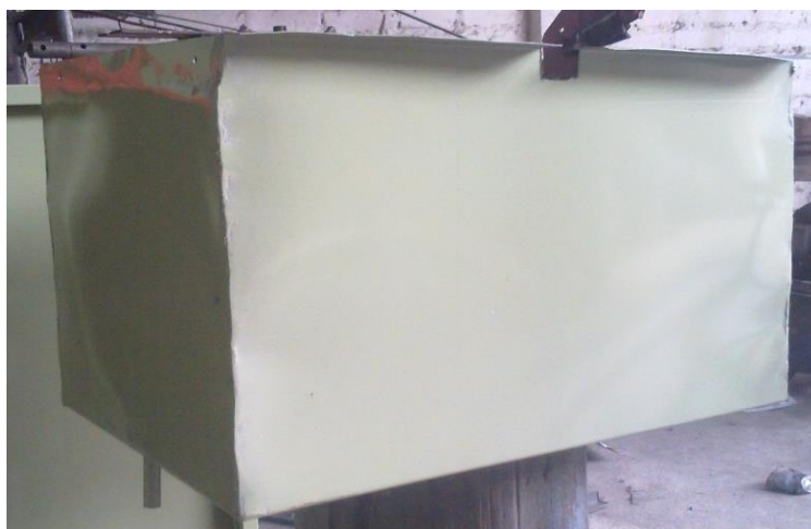
Figura 3. 26. Reservorio del aceite hidráulico.
