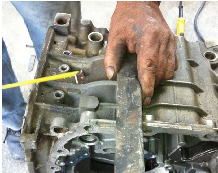
Figura 3. 9. Medición de la base del cuerpo de válvulas.
