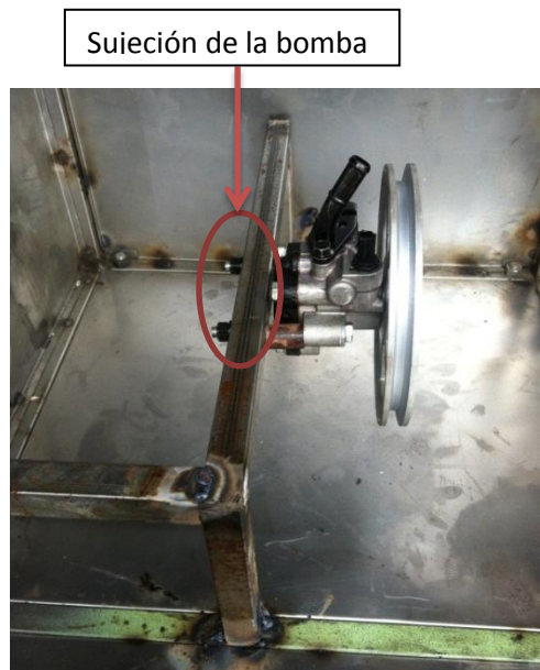
Figura 3. 40. Bomba hidráulica fijada al banco de pruebas.
