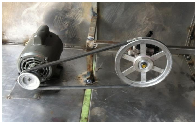
Figura 3. 44. Conjunto motor eléctrico – bomba hidráulica.
