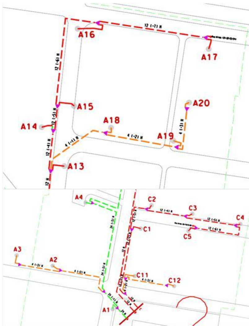
Figura 3.21 Detalle del Modelo de Despliegue de la Red de Distribución. Fuentes: Autores.
