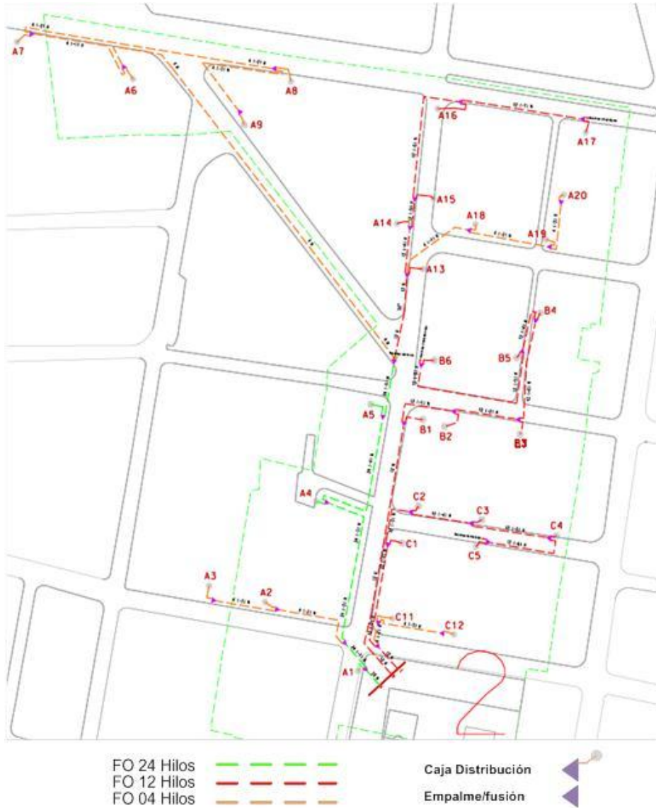
Figura 3.20 Modelo de Despliegue de la Red de Distribución.
