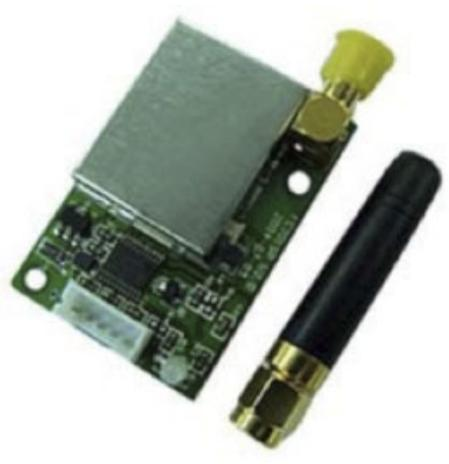
Figura 4.18: Modulo Transmisión RF
