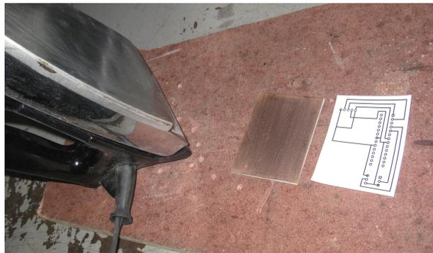
Figura 5.7: Elementos para transferir la impresión (Plancha, Baquelita, Circuito impreso)
