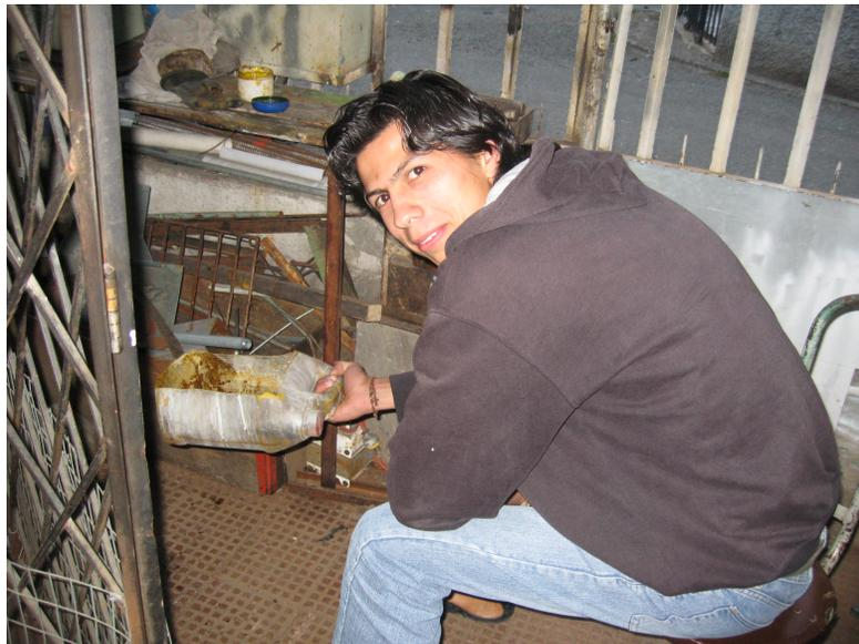
Figura 7.7: Eliminación del Cobre Sobrante de las placas
