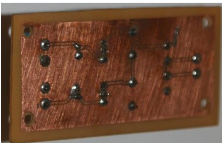
Figura 3.15. Vista de la placa de alimentación con los puntos de suelda en los componentes
