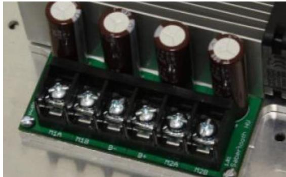
**Figura 5.39:** Terminales de la batería y motores
