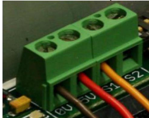
**Figura 5.40:** Terminales de voltaje y para las señales de control
