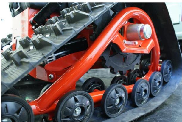
**Figura 3.9:** Silla tipo oruga TankChair (motor y transmisión)
