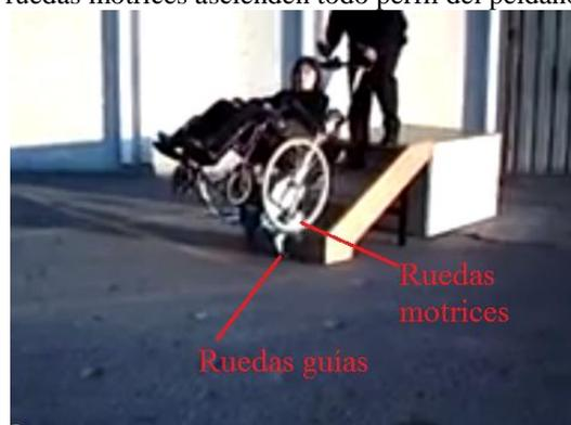
**Fase 3:** Ruedas motrices descansan sobre el peldaño, ruedas guías se empiezan a retraer.
