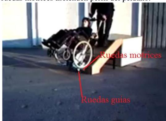
**Fase 2:** Ruedas guías se mantiene en el piso, ruedas motrices ascienden todo perfil del peldaño
