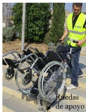
**Figura 3.11:** Sube escaleras YACK 912 prueba de funcionamiento **Figura 3.12:** Sube escaleras YACK 912 - ruedas de apoyo
