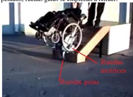
**Fase 4:** Ruedas motrices descansan sobre el peldaño, ruedas guías se retraen totalmente
