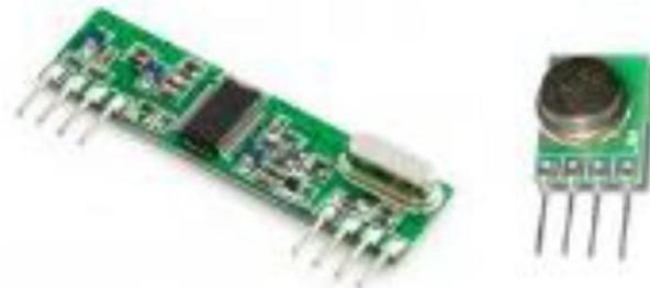
Figura 5.33: Transmisor y receptor de radiofrecuencia
