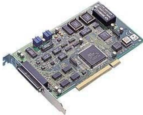
Figura 3:"Tarjeta PCI 1117"[4]
