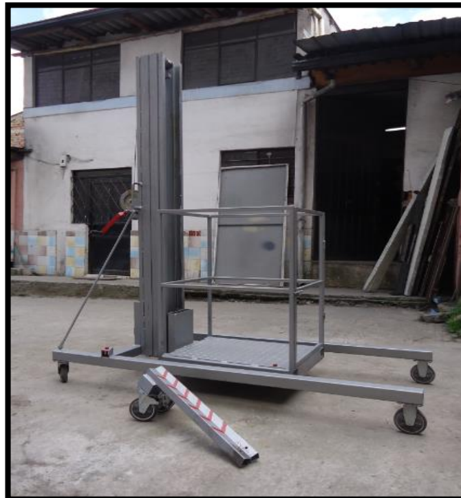
Foto (6) Elevador vertical manual tipo apilador desmontado los estabilizadores
