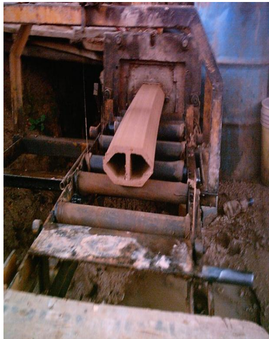
Imagen 12: Moldeado de ladrillos
