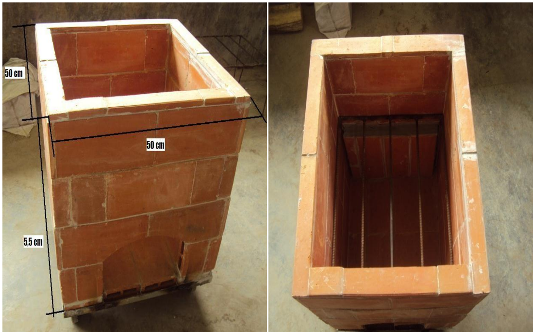
Imagen 15: Dimensiones para el horno
