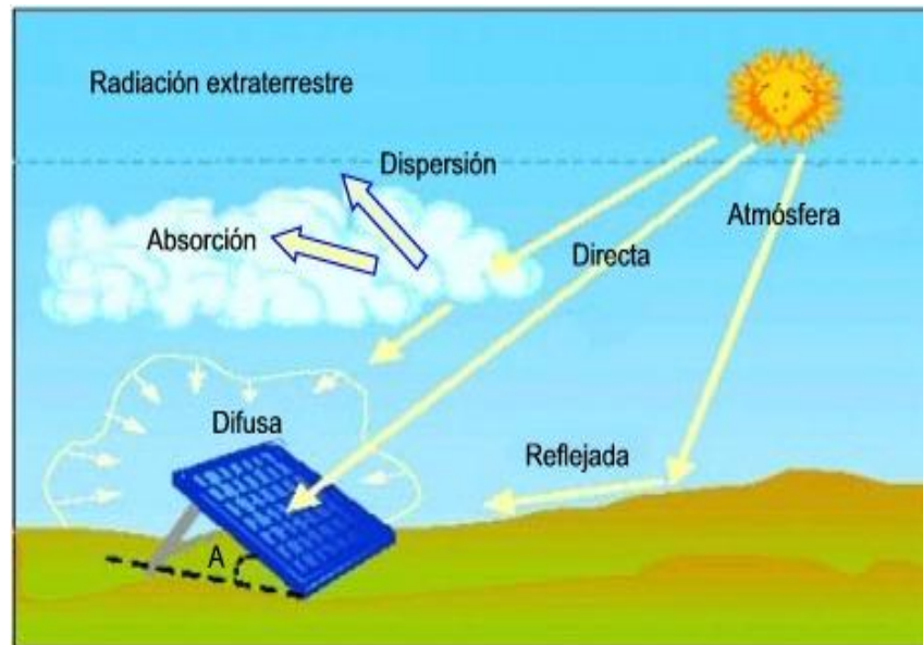
Figura 2.5: Descripción gráfica de los tipos de radiación solar 25
