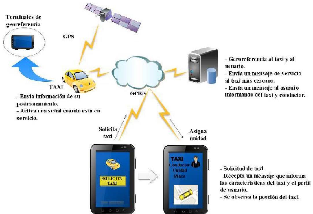
Figura 2.21: Sistema de gestión de flota mediante teléfonos web (Fuente Autor).
