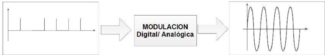
Figura 1.3: Modulación de digital a analógica ( Fuente Autor ).
