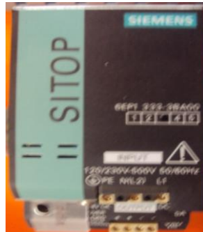
Figura 37: Fuente modular Sitop 24V/5A
