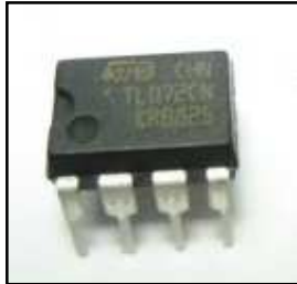
Figura 42 Amplificador operacional TL072
