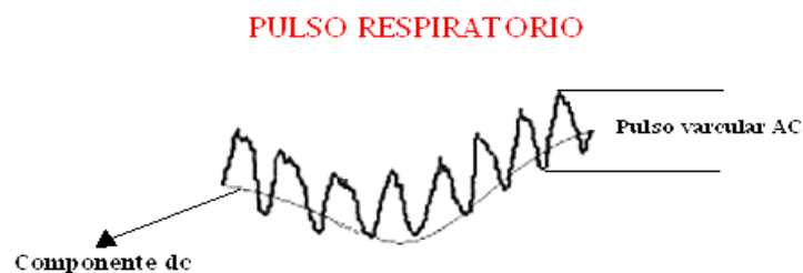
Figura 12: Componentes de la Onda Fotopletismográfica
