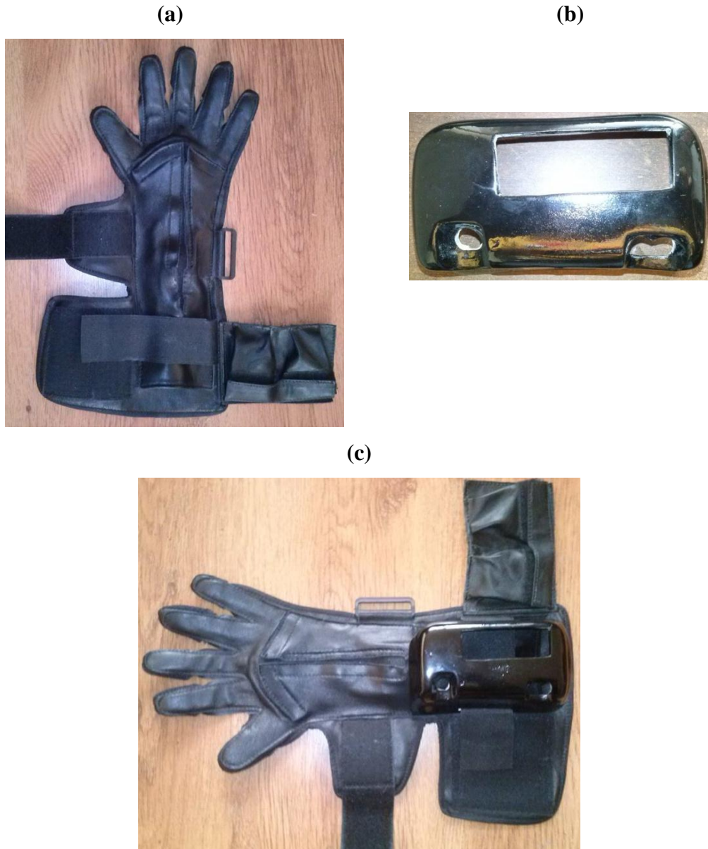
Figura 36 a) Guante, b) Cubierta del circuito y c) Acoplamiento de guante y cubierta
