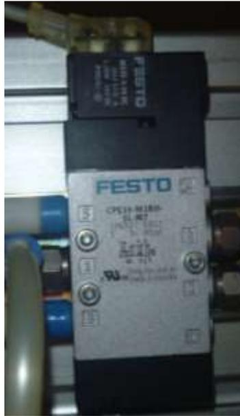
Figura 33: Válvula electro neumática
