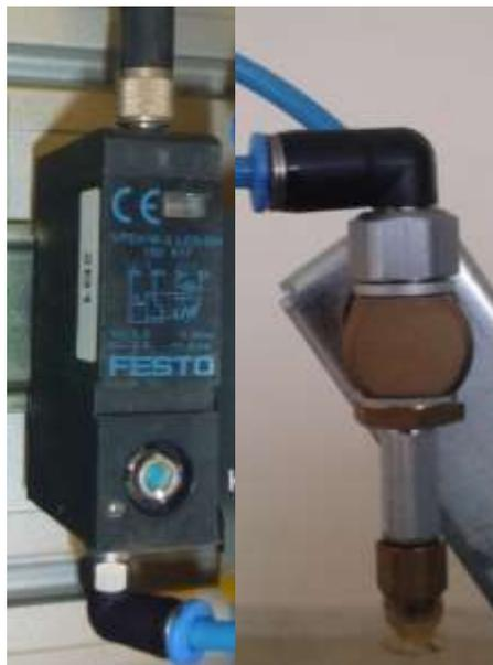
Figura 32: Presostato y copa de succión
