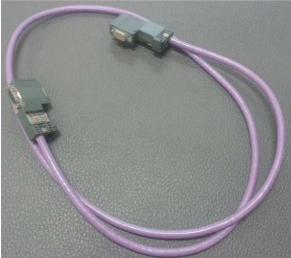
Figura 21: Cable profibus con conectores
