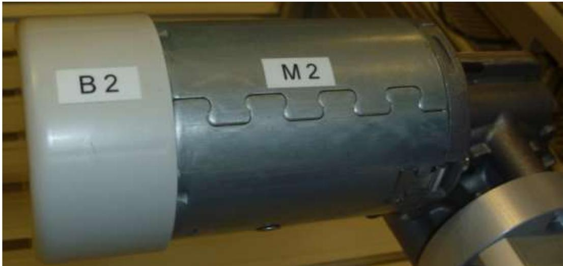
Figura 37: Motor con encoder
