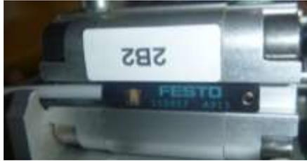
Figura 36: Sensor magnético sobre un pistón
