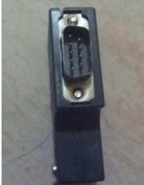
Figura 22: Conector profibus con resistencia terminadora
