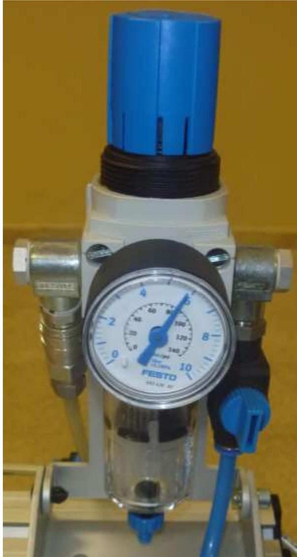
Figura 35: Filtro con regulador para aire comprimido
