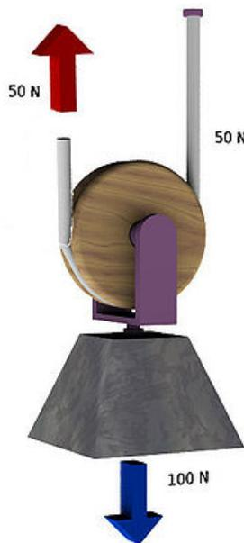
**Figura 2. 18** Polea simple móvil.
