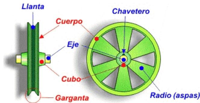
Figura 2. 19 Partes de una polea
