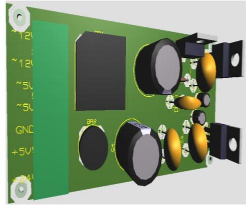
Figura 2.39: Construcción del PCB de la fuente de alimentación
