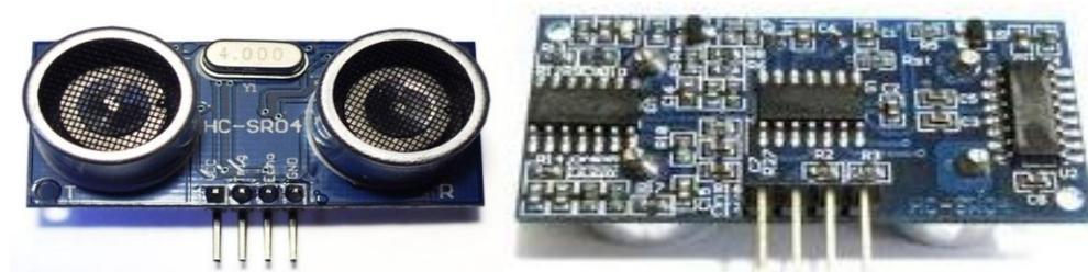
Figura 2.20: Sensor de ultrasonido hc-sr04
