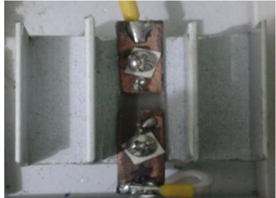
*Figura 2.16: Unión del disipador de calor, el led y el porta Led*
