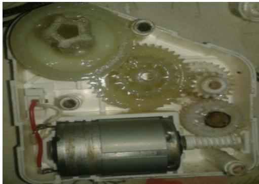
Figura 2.33: Mecanismo de corona y tornillo sin fin del motor DC
