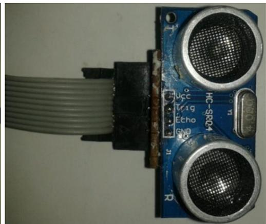
*Figura 3.27: Conexión de sensor de ultrasonido con el bus de datos*
