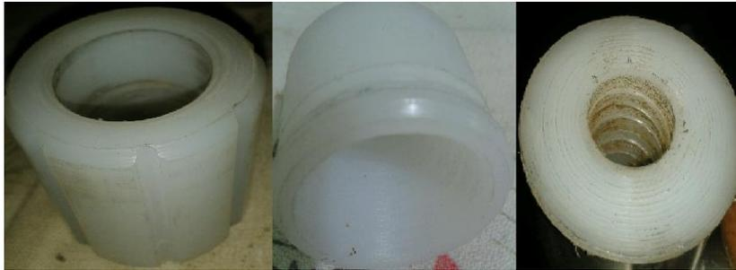
*Figura 3.17: Construcción de las piezas de grillón (seguro roscado, porta Led y los bujes del brazo superior)*
