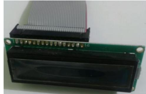
*Figura 3.28: Ubicación del LCD en la Lámpara*      *Figura 3.29: Conexión del LCD con el bus de datos*
