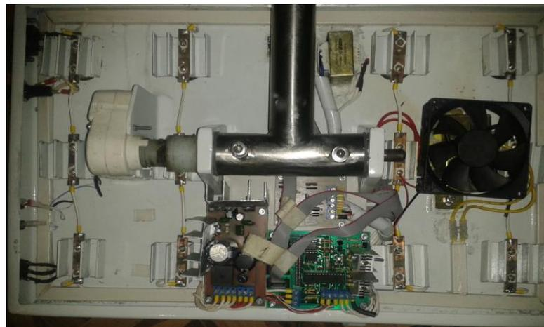
*Figura 3.30: Acoplamiento electrónico y eléctrico de la matriz de Leds*
