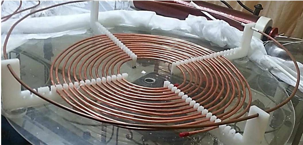
**Figura 22 Bobina Primaria Construida (Hurtado y Villamar, 2014)**
