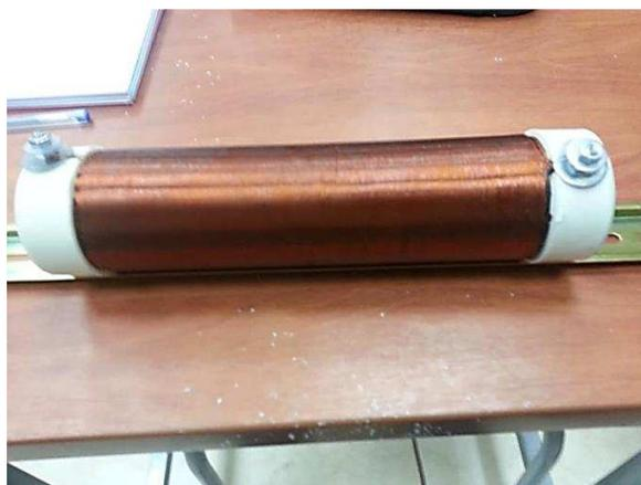
Figura 18 Bobinas de Choque - Construcción (Hurtado y Villamar, 2014)
