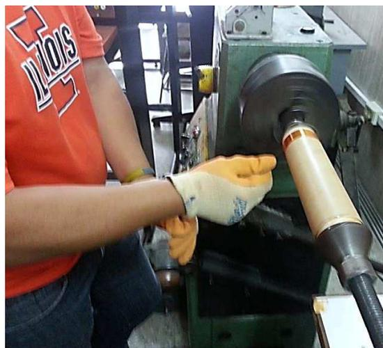
Figura 17 Bobinando las Bobinas de Choque (Hurtado y Villamar, 2014)
