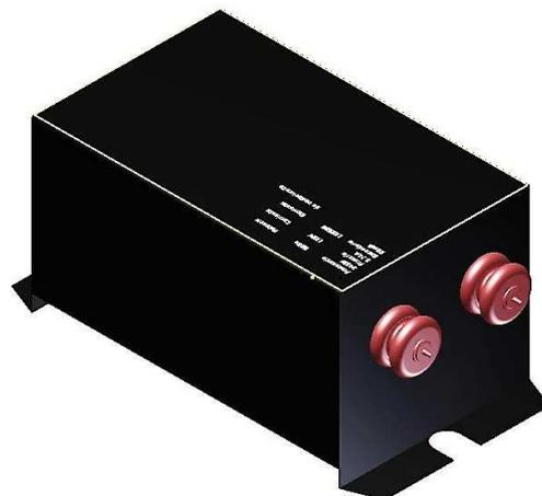
**Figura 2** Transformador de Neón dibujado en Inventor (Hurtado y Villamar, 2014)
