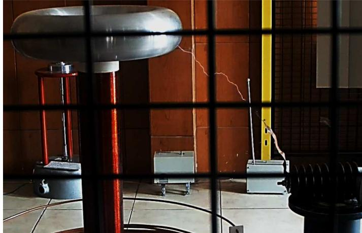
**Figura 34 Prueba de Asilamiento realizado en Laboratorio (Hurtado y Villamar, 2014)**
