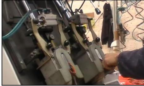
**Imagen 18.** Conformadora de talón.
