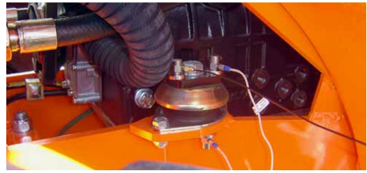
Figura 2.12: Referencia de estudio para el aislamiento vibratorio. Fuente:[36]
