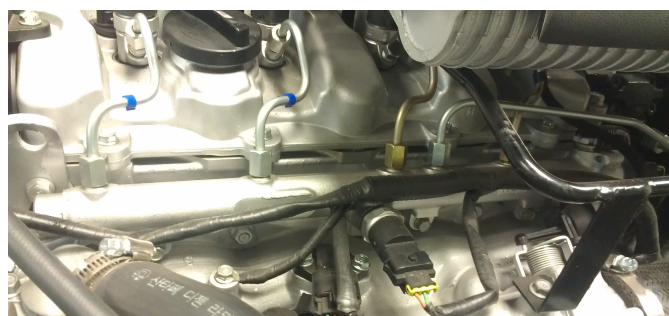
Figura 1.8: Rail acumulador de presión. Fuente: Autores.
