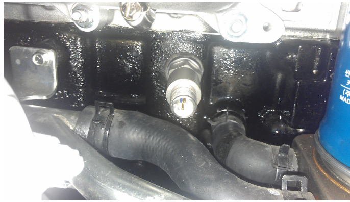
Figura 4.3: Ubicación del acelerómetro unidireccional. Fuente: Autores.
