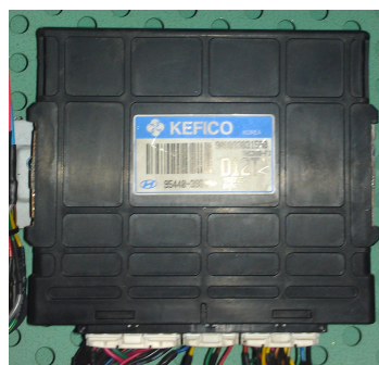
Figura 1.11: Unidad de control electrónica para un sistema common rail. Fuente: Autores.
