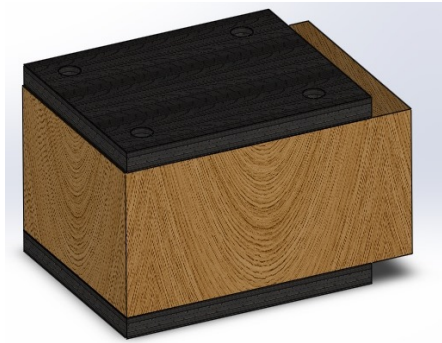
Figura 2.10: Diseño de base para el aislamiento de la vibración. Fuente: Autores
