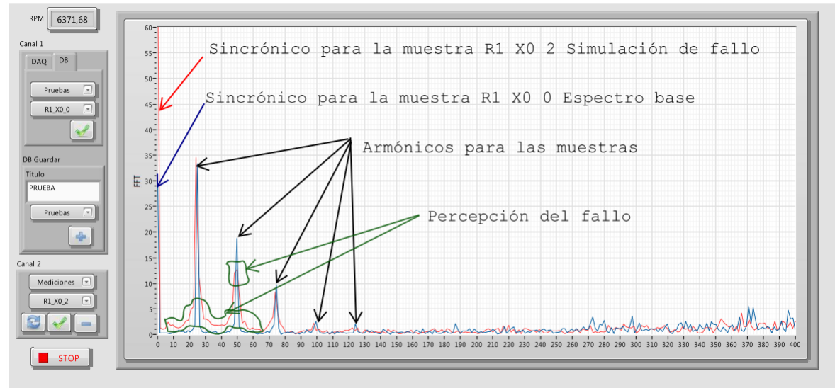
Figura 4.8: Análisis frecuencial con el software LabVIEW para el caso de estudio R1_X0.0 vs R1_X0.2. Fuente: Autores.
