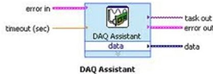
Figura 3.5: Asistente para la adquisición de datos en LabView. Fuente: Autores
