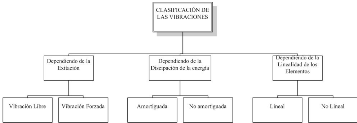
Figura 2.1: Clasificación de las vibraciones. Fuente: Adaptada de [23]
