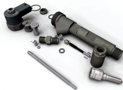
Figura 1.10: Componentes de un electroinyector. Fuente:[3]
