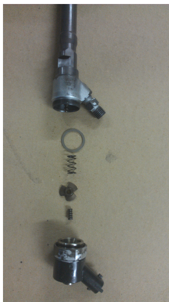
Figura 4.2: Inyector del sistema CRDI en mal estado. Fuente: Autores.
