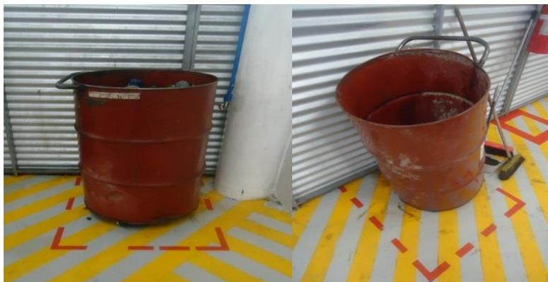
**Figura 37:** Depósitos con ruedas, agarraderas y en zona delimitadas.
