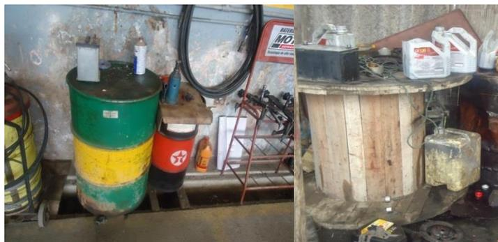
**Figura 52:** Almacenamiento de baterías en cualquier rincón del taller.
