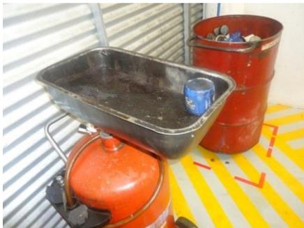
**Figura 38:** Equipo adecuado para la el escurrimiento de filtros.
