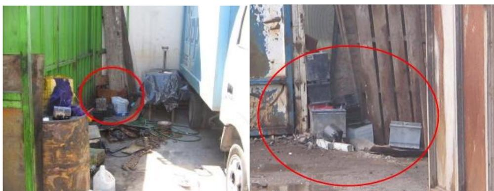
**Figura 28:** Almacenamiento inadecuado de baterías ácido plomo dentro de los talleres.
