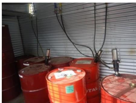
**Figura 42:** Almacenamiento de aceite virgen en tanques de 55 galones.
