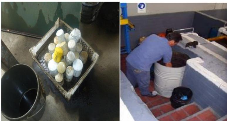
**Figura 40:** Depósito inadecuado sin malla de escurrimiento y separación de filtros.
