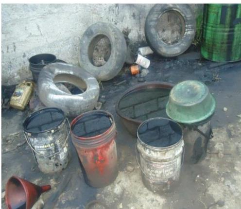
**Figura 32:** Uso de depósitos inadecuados fuera de áreas temporales.
