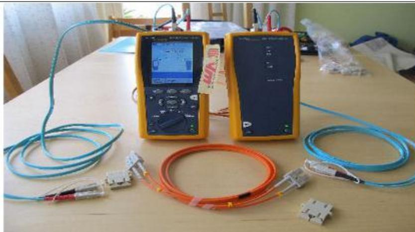
**Figura 28:** Elementos de certificación de una fibra óptica.
