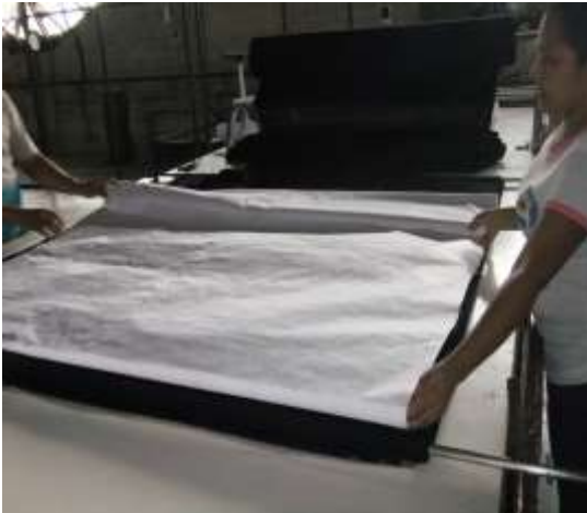
Figura No 4.13.- Tendido de tejidos previo al corte
