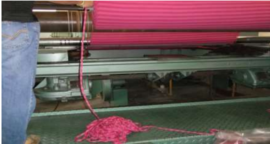
Foto No 4.9.- Corte de orillos
