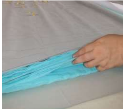
Figura No 4.13.- Tendido de tejidos previo al corte
