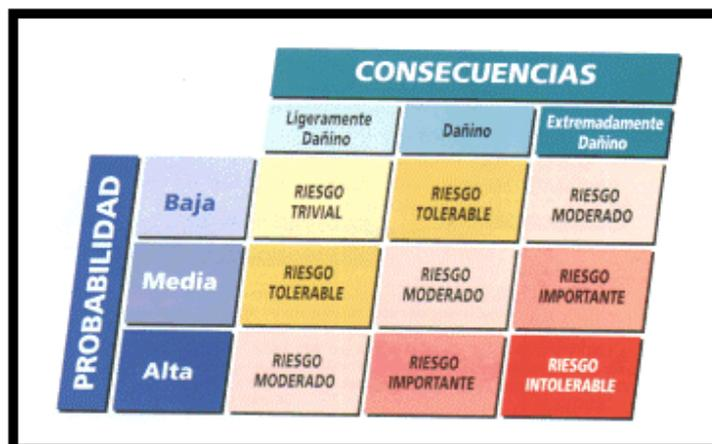
La imagen muestra una matriz de análisis de riesgos con un eje vertical de 'PROBABILIDAD' (Baja, Media, Alta) y un eje horizontal de 'CONSECUENCIAS' (Ligeramente Dañino, Dañino, Extremadamente Dañino). Las celdas de la matriz indican niveles de riesgo: Riesgo Trivial, Riesgo Tolerable, Riesgo Moderado y Riesgo Importante/Intolerable.
