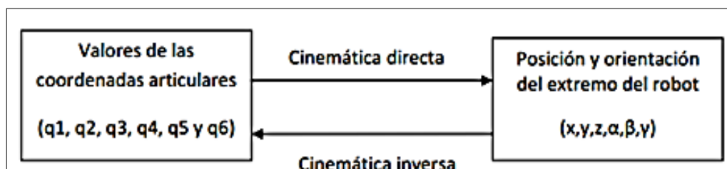
Figura 1 Diagrama de relación entre cinemática inversa y directa
