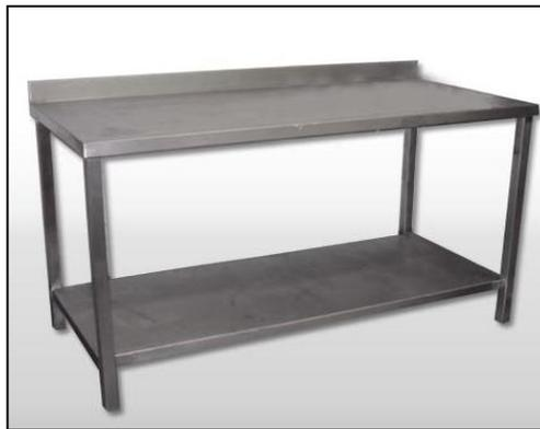
Mesa diseñada para trabajo pesado. 100% acero inoxidable, soldadas con refuerzo en acero inoxidable tipo sandblasting. Lámina de la mesa calibre 16 con omegas del mismo calibre, pozuelo y entrepaño calibre 18, tubería cuadrada calibre 1 ½ con niveladores de ½” acero inoxidable, sin entrepaño se cierra con la misma tubería de las tapas. Altura de 900 mm con tienen tornillos graduables que permiten una altura mínima de 850 mm.
