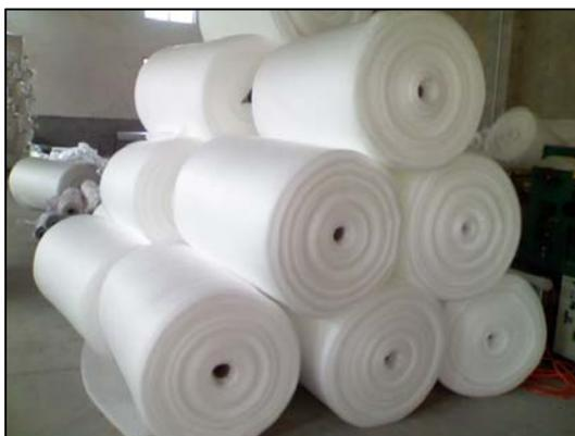
**FIGURA 1. 20 - ROLLOS DE POLIETILENO EXPANDIDO**
