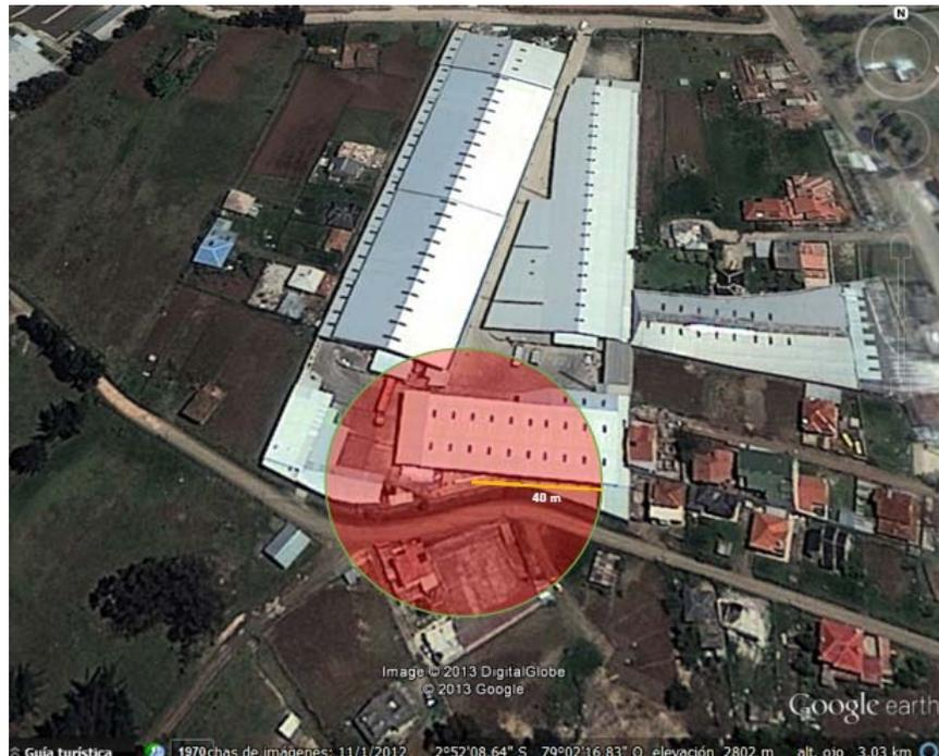
**Figura C1 - Conclusiones Radio de F&E - Dow Chemical)**
