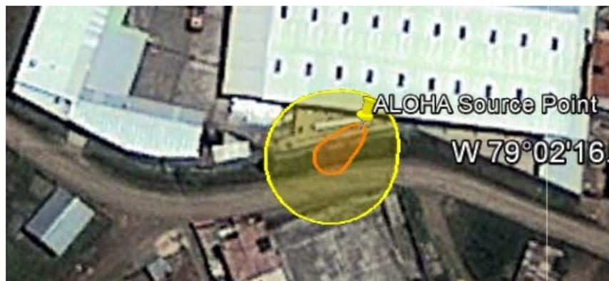
**FIGURA 2. 28 - EXPLOSION DE NUBE DE VAPOR – CASO 2
