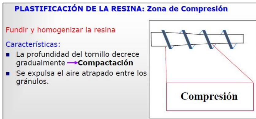
**FIGURA 1. 14 - TORNILLO DE EXTRUSIÓN - COMPRESIÓN**
