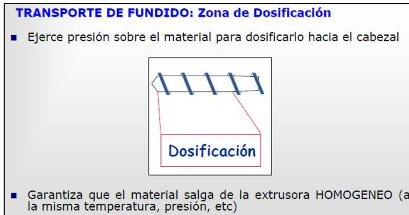
**FIGURA 1. 15 - TORNILLO DE EXTRUSIÓN - DOSIFICACIÓN**
