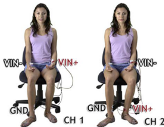
Figura 3.3.71: Forma correcta de colocar los electrodos y los cables para adquirir señales ECG. (Manual de uso BIOPAC BSL MP45).
