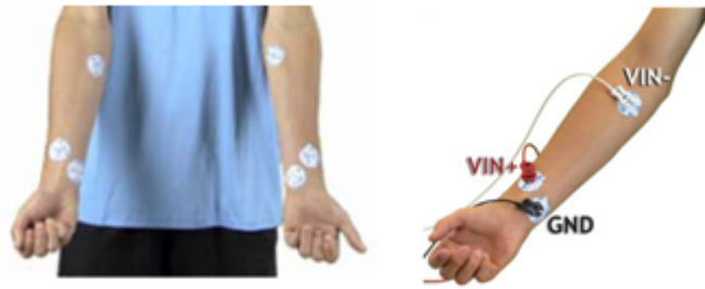
Figura 3.3.1: Forma correcta de colocar los electrodos y los cables para adquirir señales EMG. (Manual de uso BIOPAC BSL MP45).
