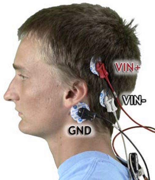
Figura 3.3.15: Forma correcta de colocar los electrodos y los cables para adquirir señales EEG. (Manual de uso BIOPAC BSL MP45).
