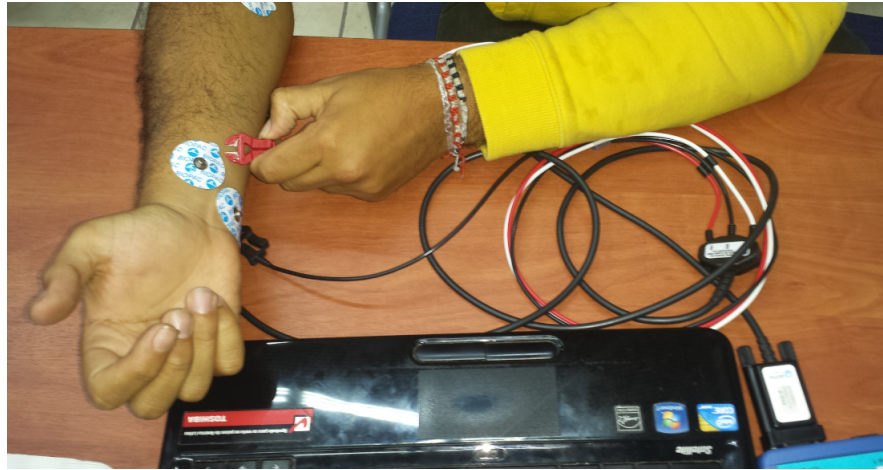
Figura 4.1.4: Correcta forma de colocación de electrodos para adquirir señales EMG
