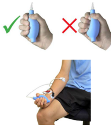
Figura 3.3.8: Forma correcta de utilizar el medidor de fuerza en la adquisición de señales EMG. (Manual de uso BIOPAC BSL MP45).adquirir señales EMG
