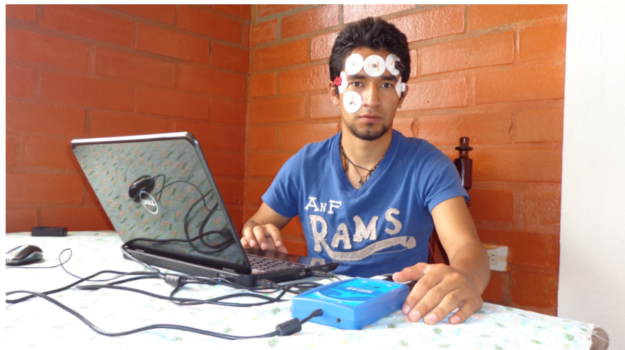
Figura 4.1.7: Colocación de los electrodos y cables para adquisición EOG.
