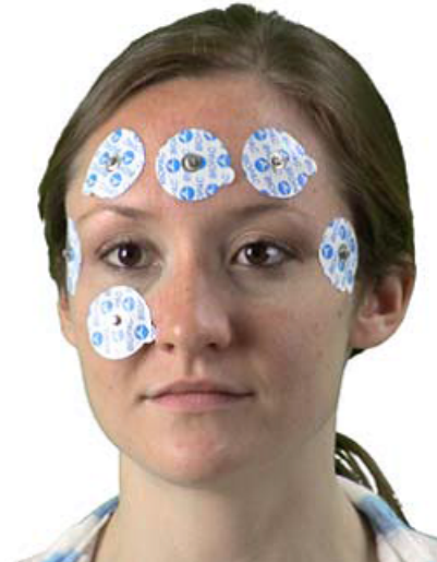
Figura 3.3.99: Forma correcta de colocar los electrodos y los cables para adquirir señales EOG. (Manual de uso BIOPAC BSL MP45).
