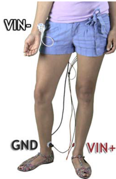
Figura 3.3.42: Forma correcta de colocar los electrodos y los cables para adquirir señales ECG. (Manual de uso BIOPAC BSL MP45).
