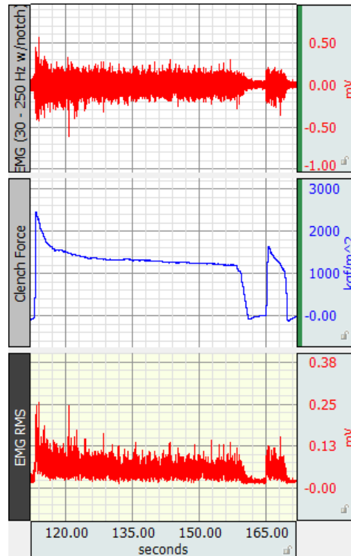
Figura 3.3.11: Adquisición y visualización de la señal EMG, señal de fuerza y RMS resultado de la actividad eléctrica del flexor de la muñeca, en un lapso de 60 segundos. .
