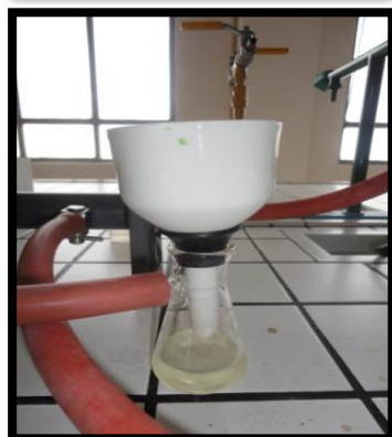
Filtrado de muestras de suelos sin contaminación de petróleo tratados por fitorremediación, luego de la agitación.
