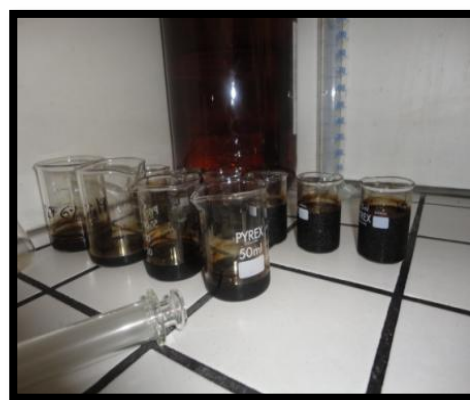
Extractos de las muestras de suelos contaminados con petróleo, colocados en vasos de precipitación previamente tarados evaporación y determinación de PTH.
