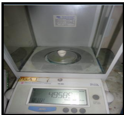
Peso de 1g. de muestra de suelo en un crisol tarado.
