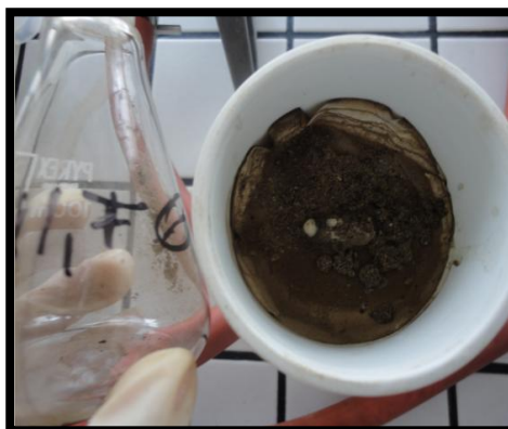
Filtrado de muestras de suelos contaminados con 3 y 6% de petróleo Tratados por fitorremediación, luego de la agitación.
