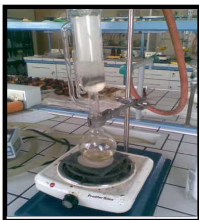
Extracción de Hidrocarburos de petróleo en equipo Soxhlet.
