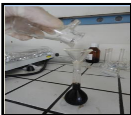
Aforado del extracto obtenido de la agitación de las muestras de suelos con Diclorometano.
