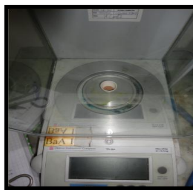
Pesaje de las muestras Incineradas.
