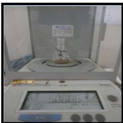
Pesaje de 5g de las muestras de suelo en matraces para agitación.
