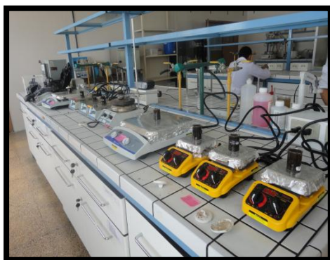
Agitación de las muestras de suelos para determinación de pH.
