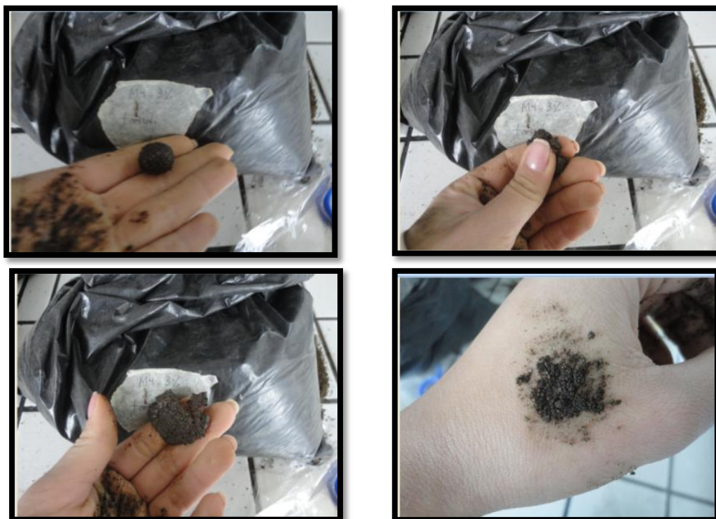
Pasos para la determinación de Textura mediante un método manual, en muestras de suelo contaminados con petróleo.
