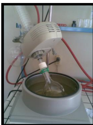
Desecación de extracto obtenido, en rotaevaporador.
