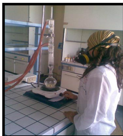
Extracción de Hidrocarburos de petróleo en equipo Soxhlet.
