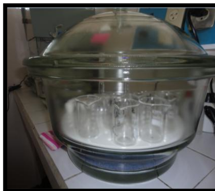
Material tarado en desecador utilizado para la determinación de TPH (Hidrocarburos Totales de Petróleo).
