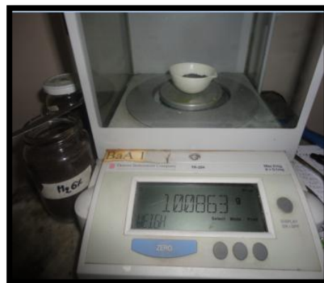
Pesaje de las muestras de suelo para determinación de Humedad.
