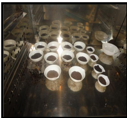
Secado de las muestras en cápsulas previamente taradas en estufa a 105°C.
