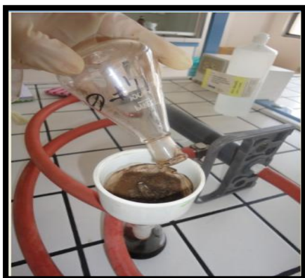
Filtrado de muestras de suelos contaminados con 3 y 6% de petróleo Tratados por fitorremediación, luego de la agitación.
