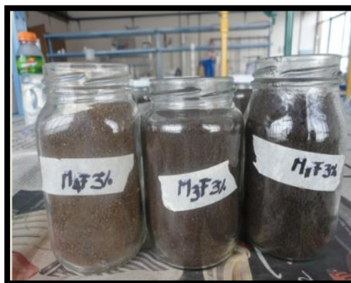
Rotulación y almacenamiento de muestras de suelo.
