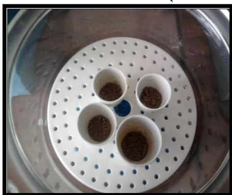
Crisoles en desecador luego de incineración en Mufla a 600°C
