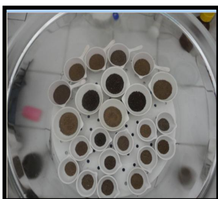
Reposo de las muestras en desecador, luego del secado en estufa.
