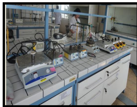
Agitación de las muestras de suelos para determinación de pH.
