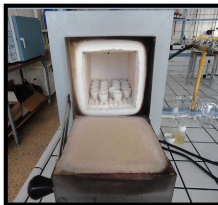
Incineración de las muestras de suelo en la mufla a 600°C.
