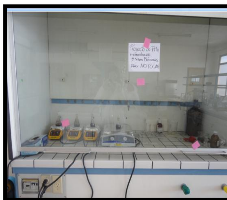
Agitación de las muestras de suelo con diclorometano (solvente), dentro de la Sorbona para evitar contaminación del ambiente por evaporación del solvente.
