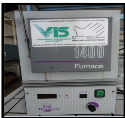
Incineración de las muestras de suelo en la mufla a 600°C.
