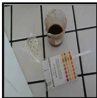
Determinación del pH mediante tirillas de medición.
