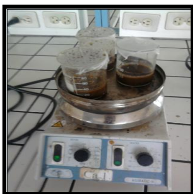
Agitación de las muestras de Suelo en agua.
